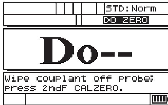
Figura 4-1 Compensação de zero do transdutor
