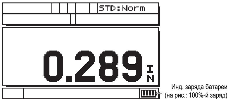
Рис. 2-1 Индикатор питания при использовании батарей
