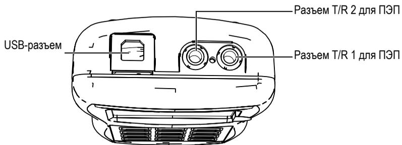
Рис. 1-3 Разъемы в верхней части прибора
