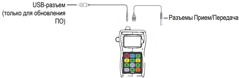
Рис. 1-2 Подключения 27MG
