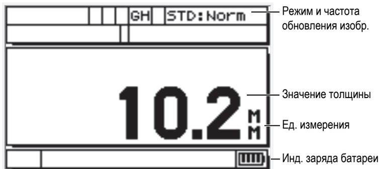
Рис. 3-1 Экран измерений
