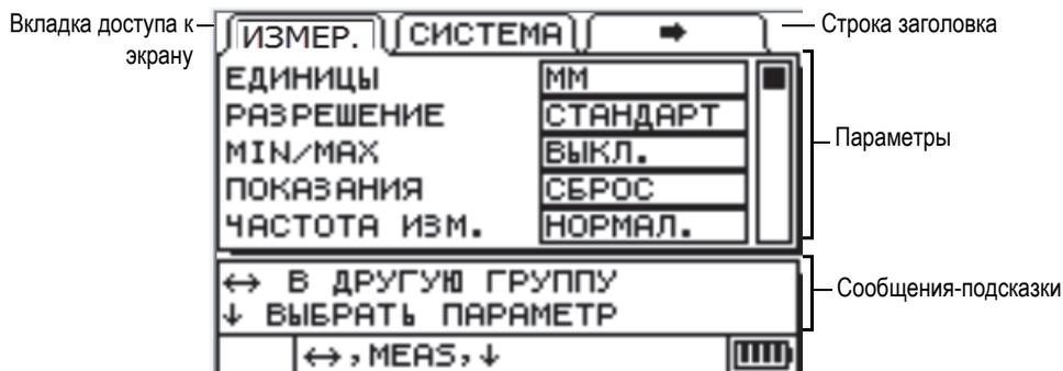
Рис. 3-3 Пример экрана параметров
