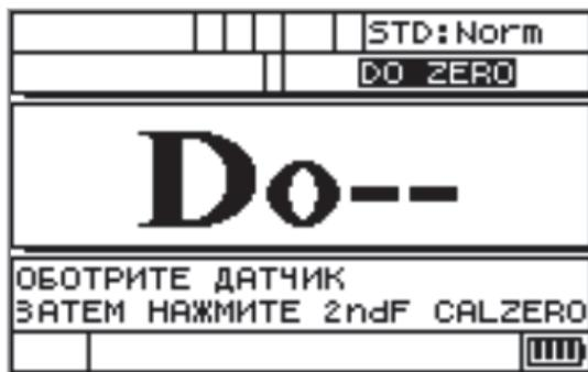
Рис. 4-1 Компенсация нуля преобразователя
