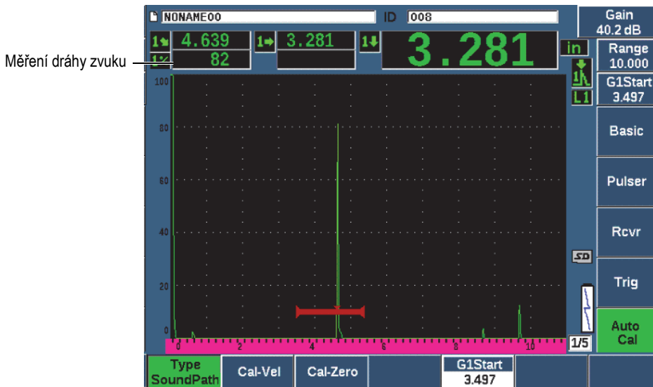
Obr. 9-20 Příklad hradlovaného signálu pro kalibraci nuly
