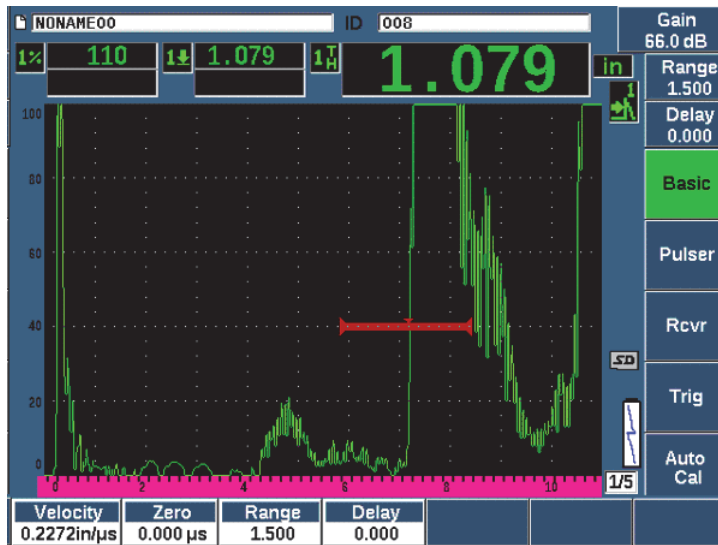
Obr. 9-12 Příklad hradlovaného signálu pro kalibraci rychlosti
