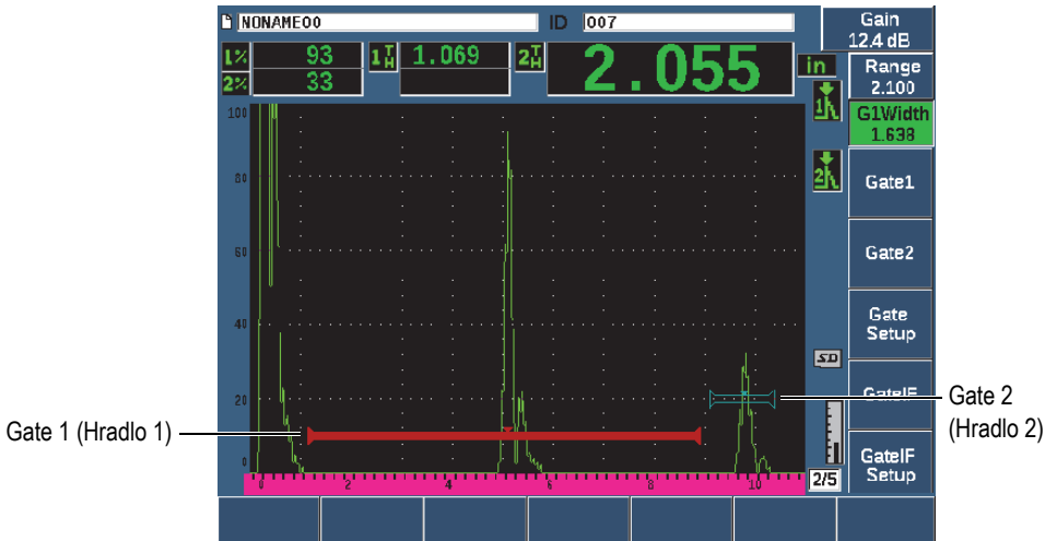
Obr. 4-8 Příklad vlnového průběhu A-zobrazení s hradly
