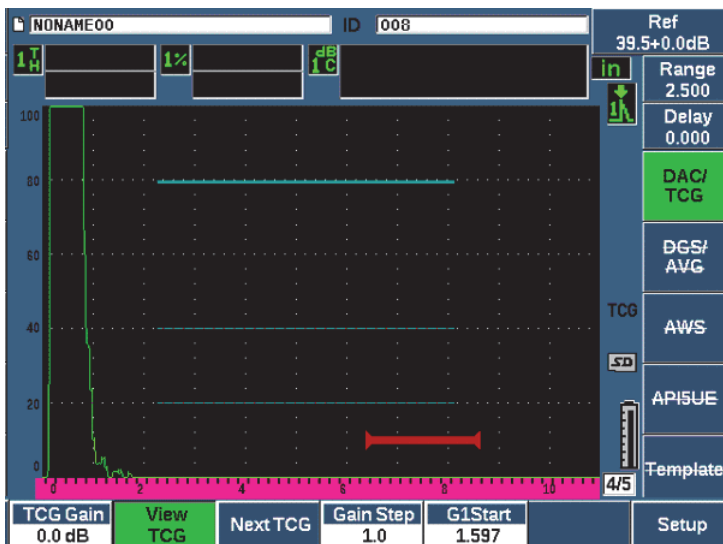
Obr. 11-7 Dokončené křivky DAC v režimu zobrazení TCG
