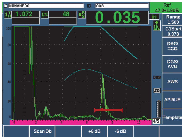
Obr. 11-17 Zesílení křivky nastavené DGS
