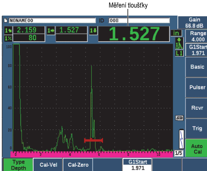
Obr. 9-26 Příklad hradlovaného signálu pro kalibraci nuly
