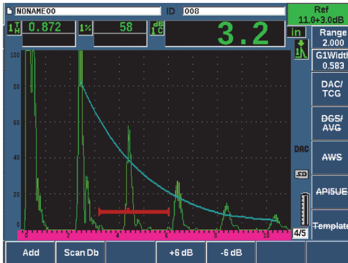
Figura 11-9 Curva DAC estándar con ganancia de escaneo en 3 dB
