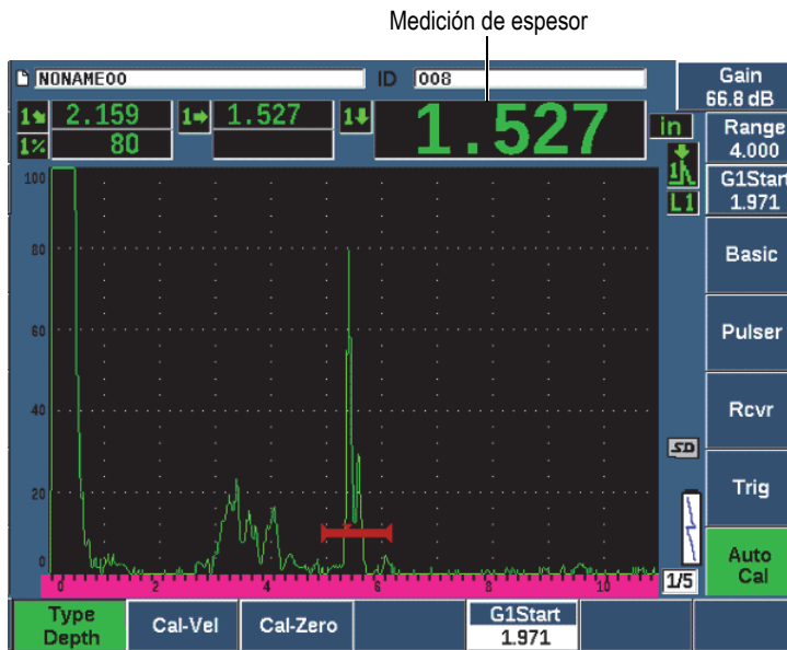
Figura 9-26 Ejemplo de una señal controlada para la calibración cero
