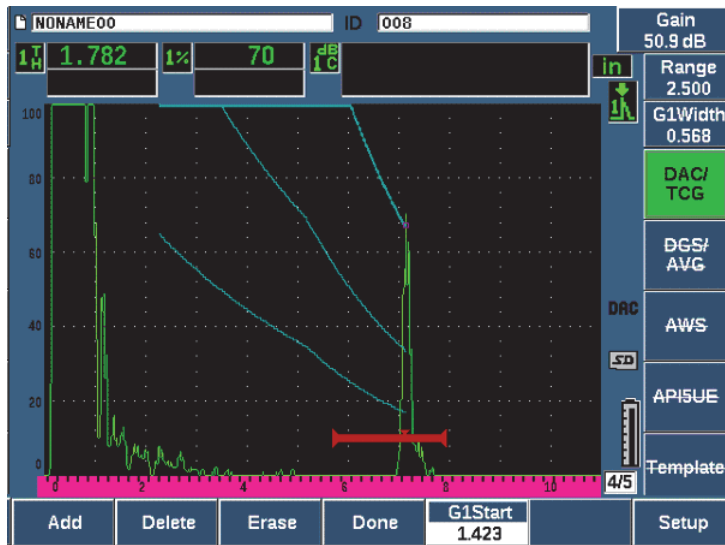
Figura 11-5 Curva DAC parcial ajustada con cada eco al 80 % de altura de la pantalla completa
