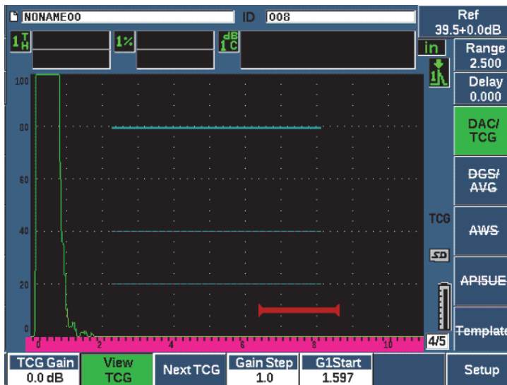
Figura 11-7 Curvas DAC completadas en el modo de visualización TCG
