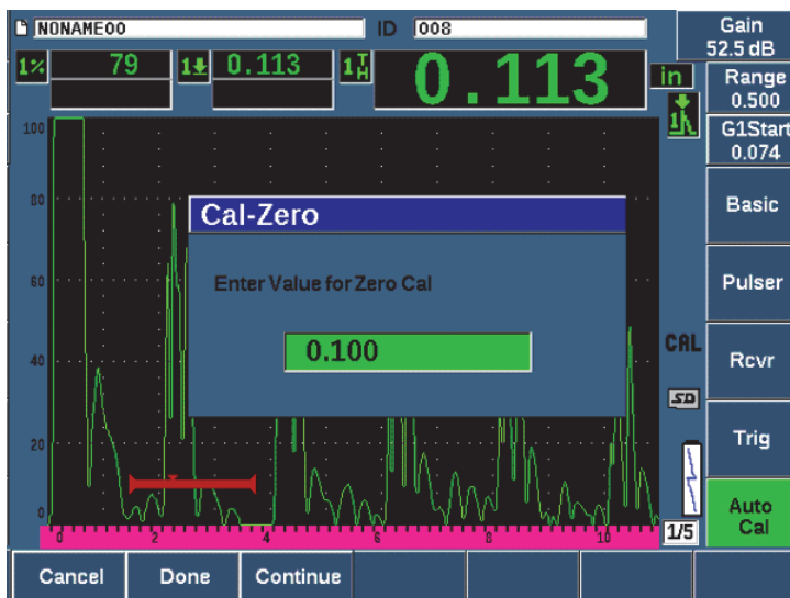
Figura 9-7 Introducción del valor de espesor de calibración cero
