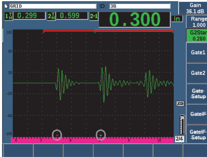
Figura 11-43 Error de medición de eco
