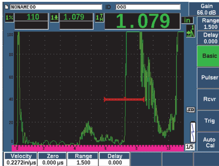
Figura 9-12 Ejemplo de una señal controlada para la calibración de velocidad
