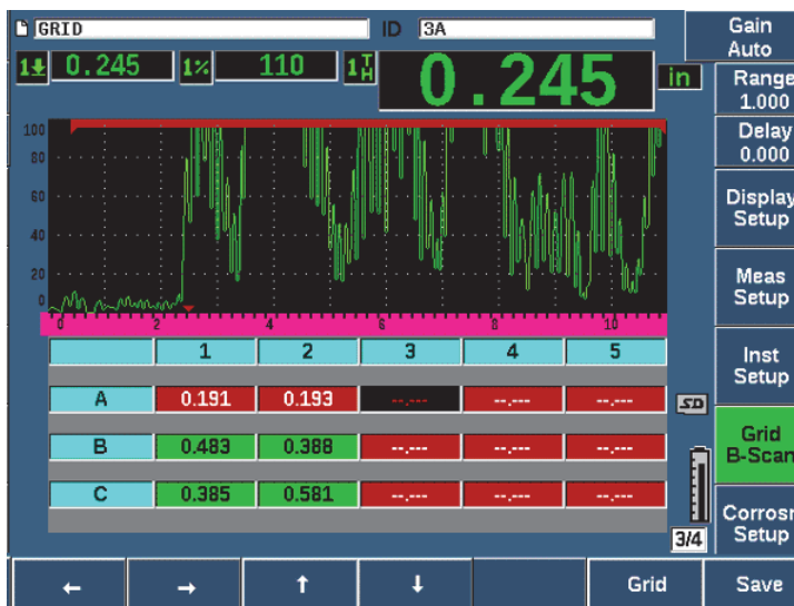
Figura 11-37 Cuadrícula de módulo de corrosión
