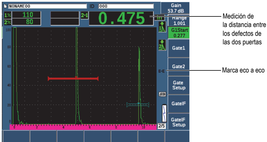
Figura 7-7 Ejemplo de una medición eco a eco
