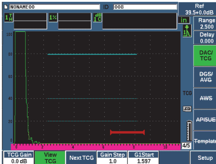
Figure 11-7 Courbes DAC complétées en mode d'affichage TCG
