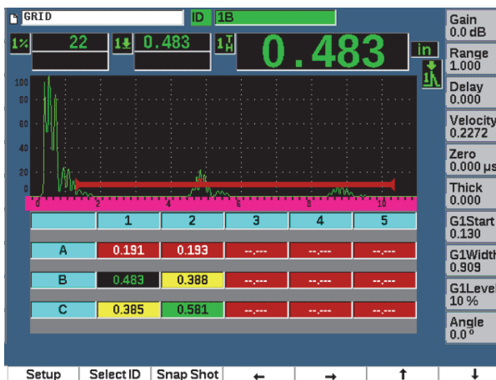
Figure 10-26 Commandes de la grille sur la fenêtre Contents
