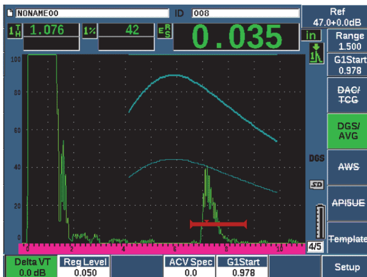
Figure 11-16 Courbes DGS/AVG à l'écran
