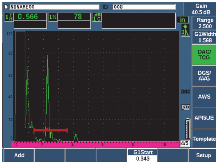
Figure 11-3 Première étape de configuration de la courbe DAC
