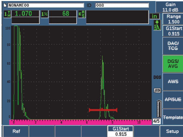
Figure 11-15 Réflecteur de référence avant la capture
