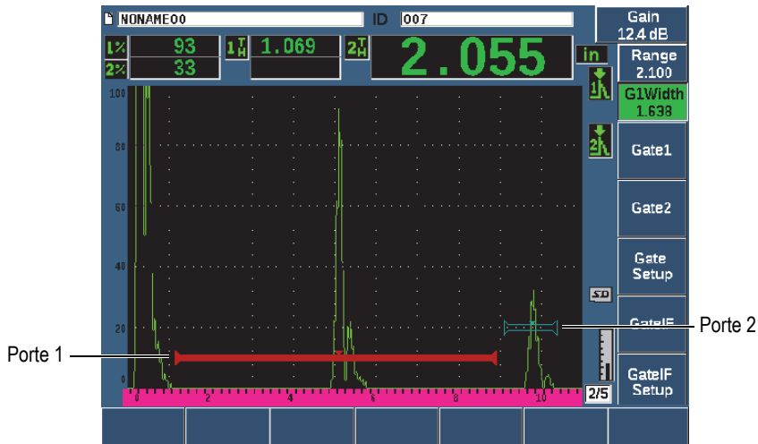
Figure 4-8 Signaux A-scan et portes
