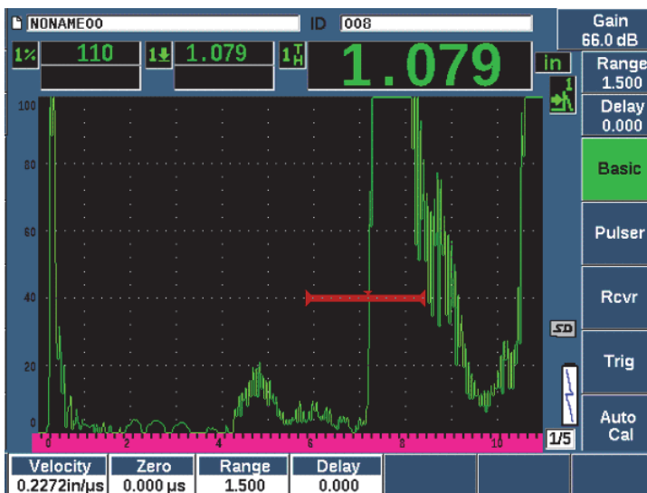
Figure 9-12 Signal placé dans la porte pour l'étalonnage de la vitesse
