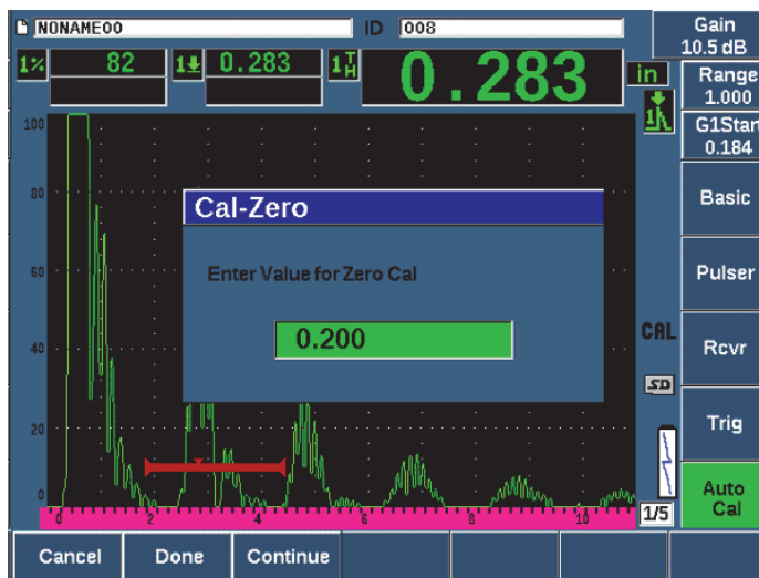
Figure 9-2 Entrée de la valeur d'épaisseur d'étalonnage du zéro
