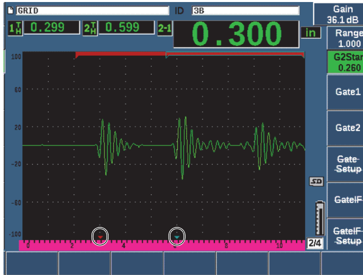
Figure 11-43 Erreur de mesure de l'écho
