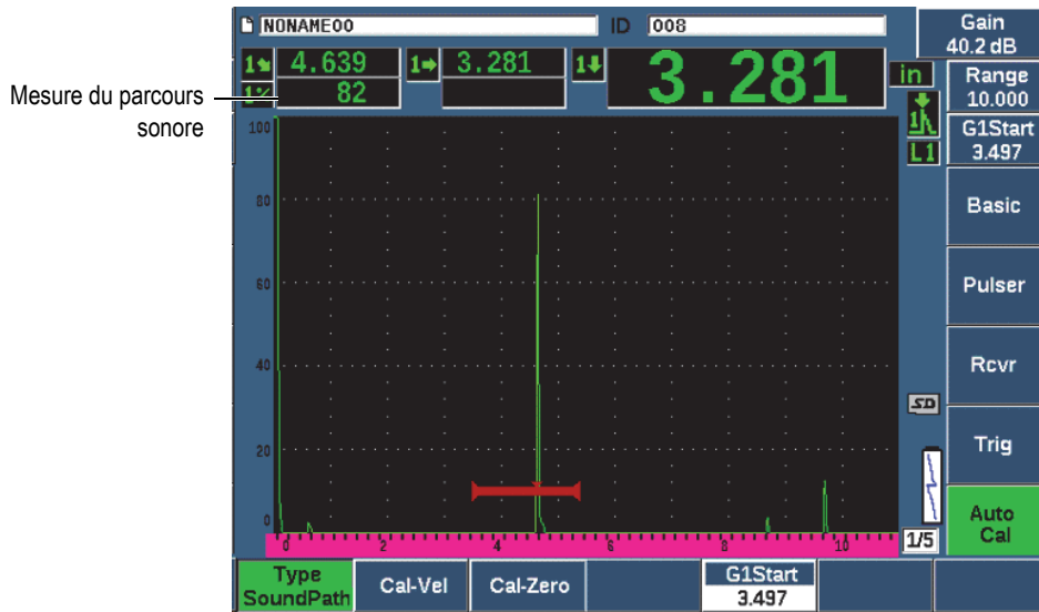
Figure 9-20 Signal placé dans la porte pour l'étalonnage du zéro
