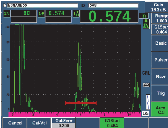
Figure 9-3 Signal placé dans la porte pour l'étalonnage de la vitesse
