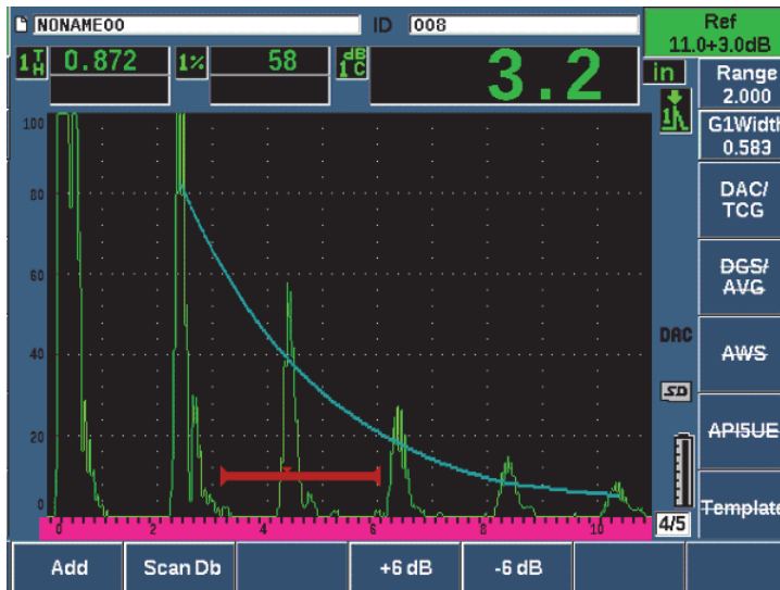
Figure 11-9 Courbe DAC de type standard avec gain de balayage à 3 dB
