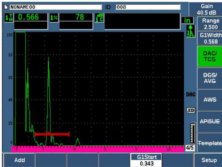
Figura 11-3 Prima fase di configurazione della DAC
