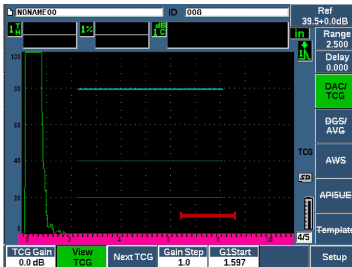
Figura 11-7 Curve DAC completate in modalità vista TCG
