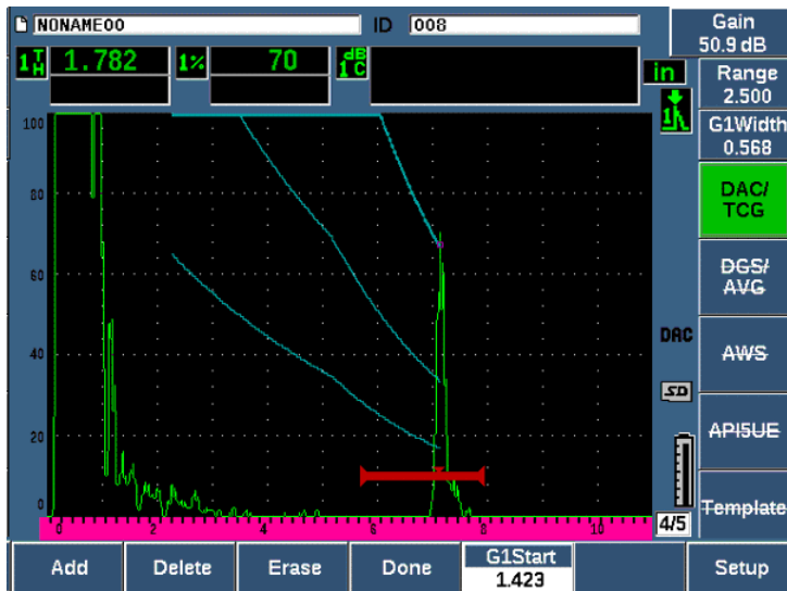
Figura 11-5 La curva DAC parziale con ogni eco definita all'80% dell'altezza dello schermo intero
