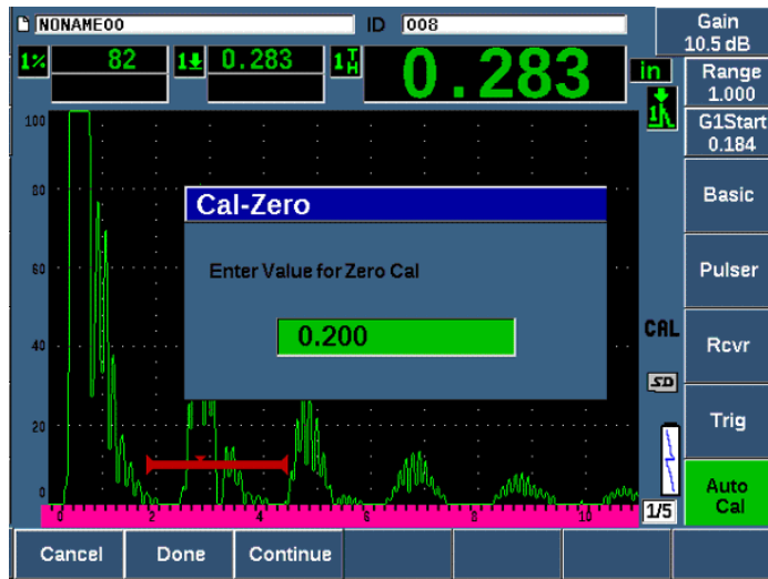
Figura 9-2 Inserimento del valore dello spessore della taratura dello zero
