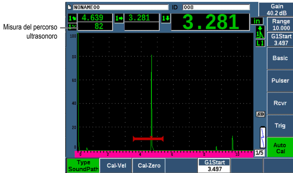
Figura 9-20 Esempio di un segnale rilevato dal gate per una taratura dello zero
