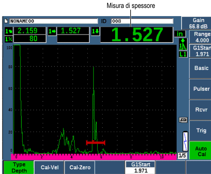
Figura 9-26 Esempio di un segnale rilevato dal gate per una taratura dello zero
