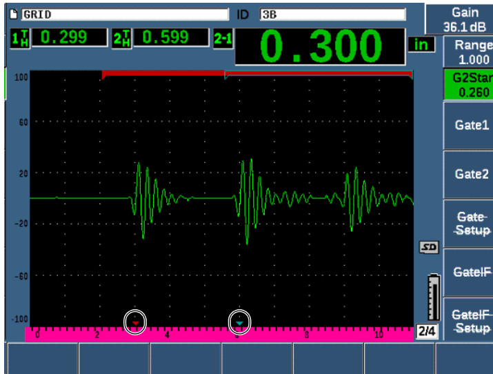
Figura 11-43 Errore di misura dell'eco
