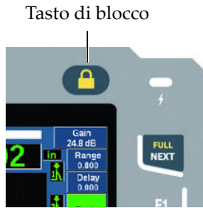
Figura 3-6 Configurazione con manopola di regolazione — Tasto di blocco
