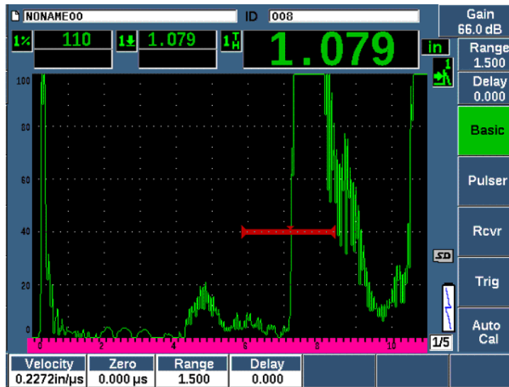
Figura 9-12 Esempio di un segnale rilevato dal gate per la taratura della velocità
