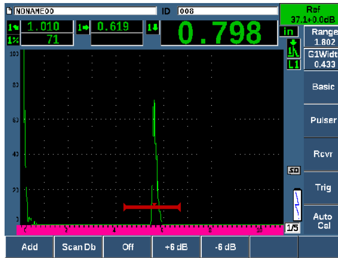
Figura 3-18 Configurazione del guadagno di riferimento
