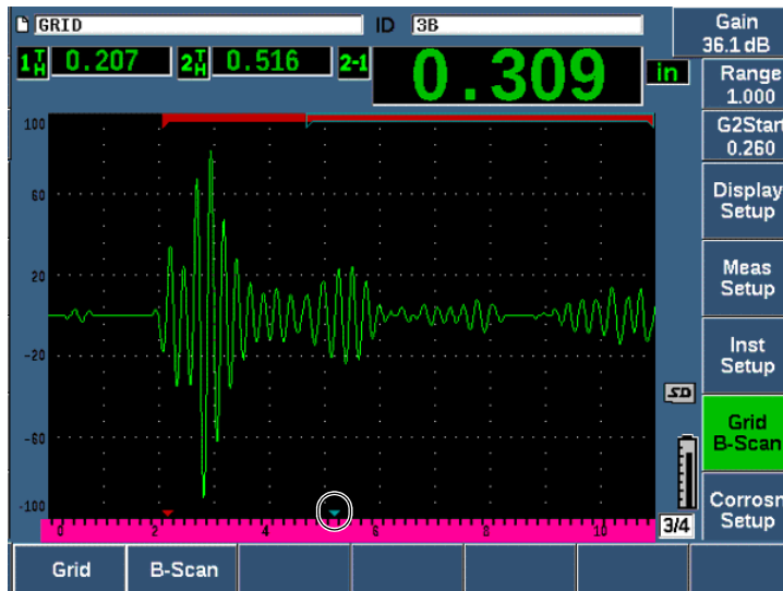
Figura 11-46 Indicatore della posizione B-scan
