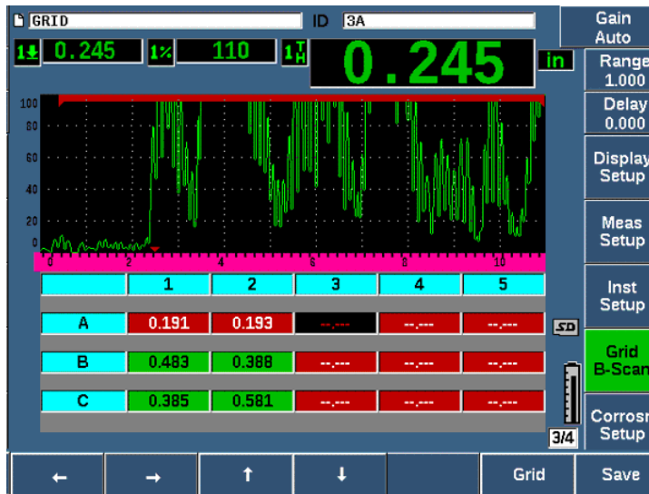
Figura 11-37 Visualizzazione della griglia del modulo per la corrosione
