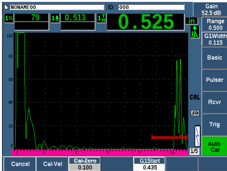
Figura 9-8 Esempio di un segnale rilevato dal gate per la taratura della velocità
