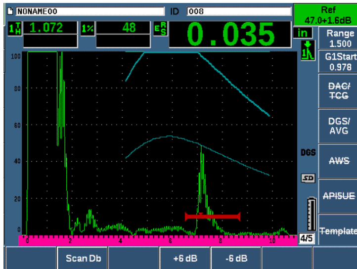
Figura 11-17 Configurazione DGS/AVG con guadagno della curva
