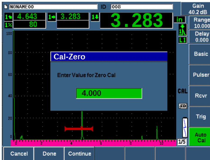
Figura 9-21 Inserimento del valore dello spessore della taratura dello zero
