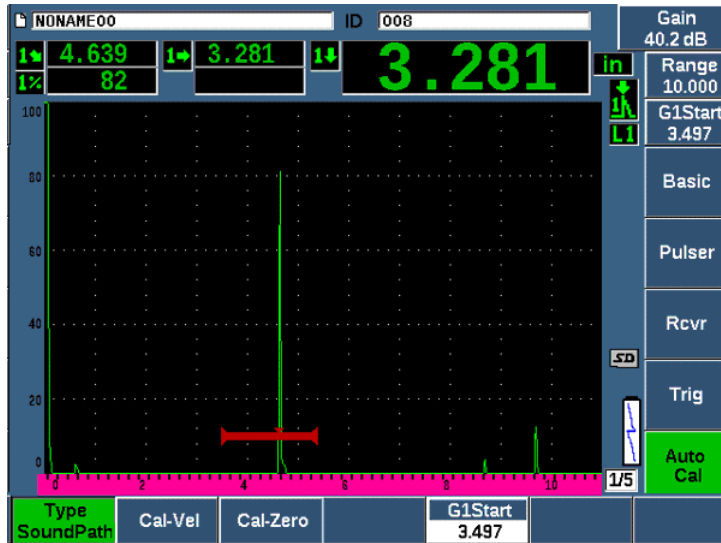
Figura 9-22 Esempio di un segnale rilevato dal gate per la taratura della velocità
