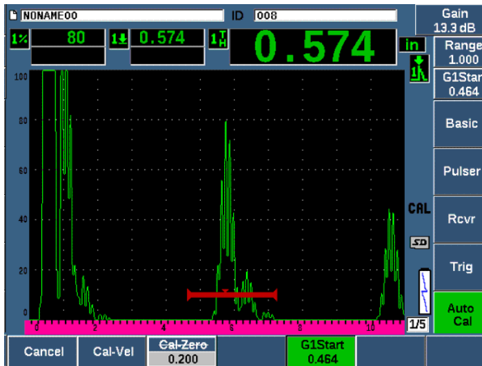
Figura 9-3 Esempio di un segnale rilevato dal gate per la taratura della velocità
