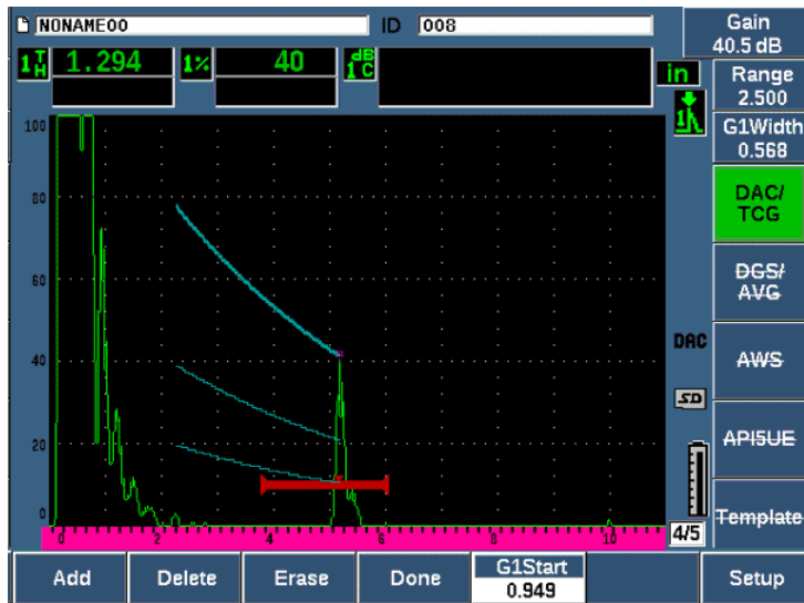
Figura 11-4 Un punto della configurazione DAC
