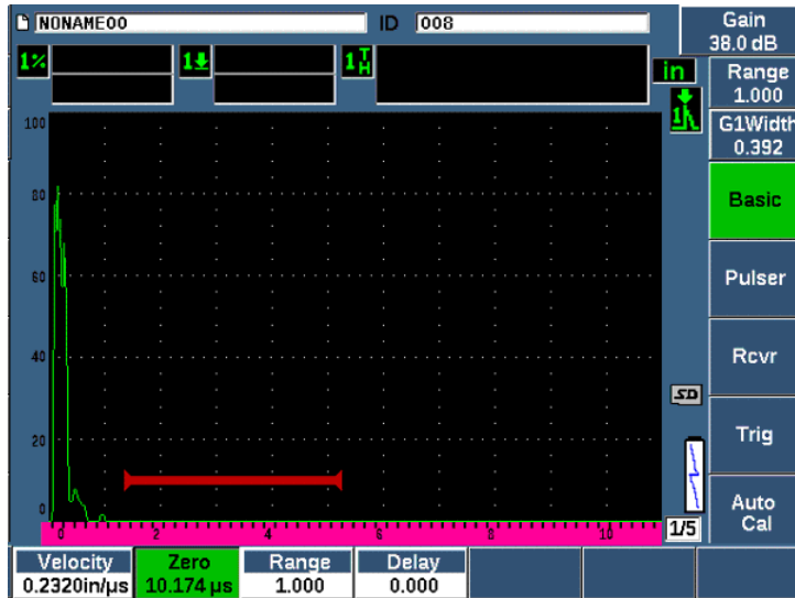
Figura 9-5 Regolazione dell'offset dello zero per la prima eco della linea di ritardo
