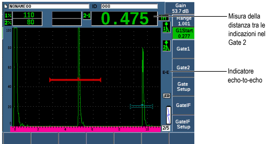
Figura 7-7 Esempio di misura echo-to-echo
