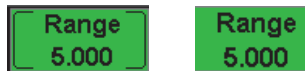
Rysunek 1-5 Wybrana regulacja zgrubna (po lewej stronie) i precyzyjna (po prawej stronie)
