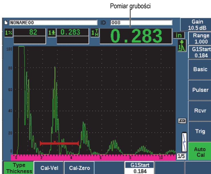
Rysunek 9-1 Przykład sygnału w bramce na potrzeby kalibracji zera
