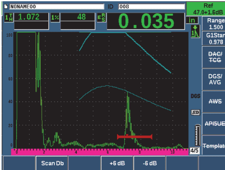
Rysunek 11-17 Regulacja DGS przy użyciu krzywej wzmocnienia
