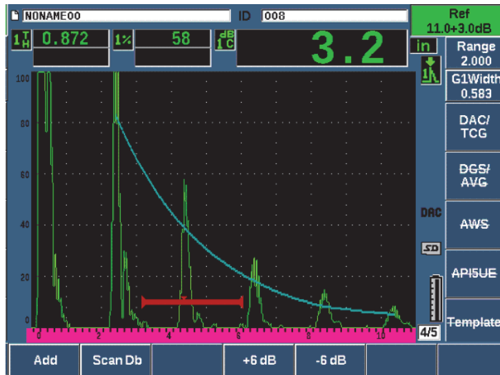
Rysunek 11-9 Standardowe DAC przy dodanym wzmacnieniu skanowania o wartości 3 dB
