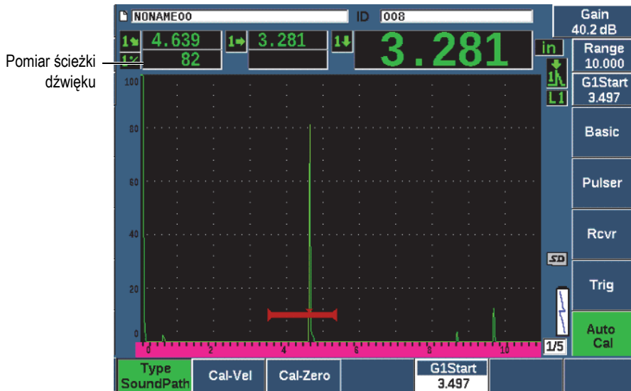
Rysunek 9-20 Przykład sygnału w bramce na potrzeby kalibracji zera
