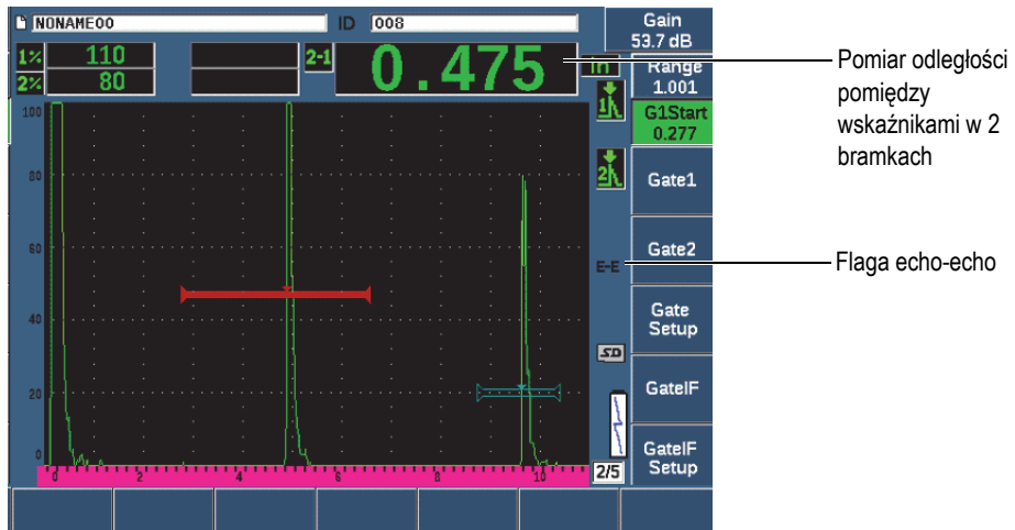
Rysunek 7-7 Przykład pomiaru echo-echo
