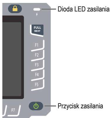
Rysunek 2-1 Lokalizacja klawisza i wskaźnika zasilania w urządzeniu EPOCH 650
