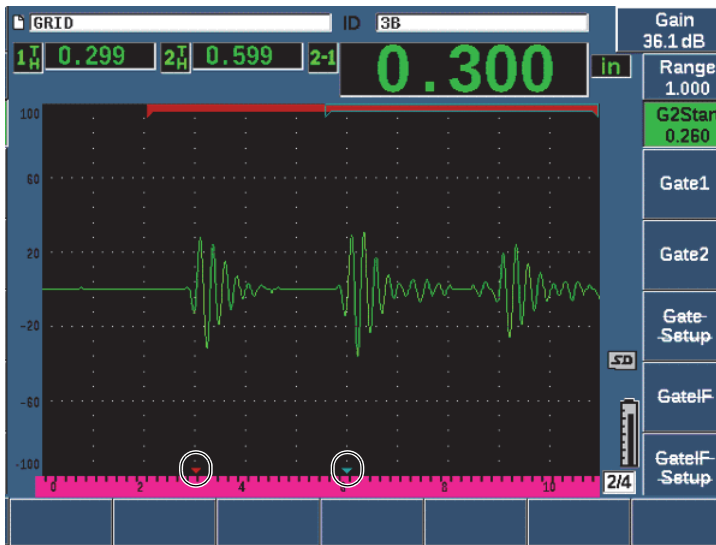
Rysunek 11-43 Błąd w pomiarze echa
