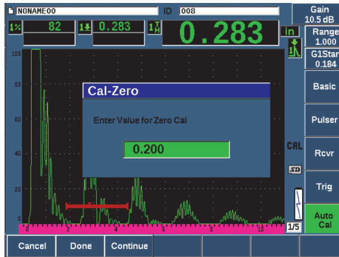
Rysunek 9-2 Wprowadzanie wartości grubości Zero Cal (Kalibracja zera)
