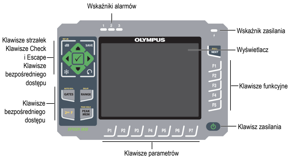
Rysunek 1-4 EPOCH 650 – konfiguracja panelu nawigacyjnego
