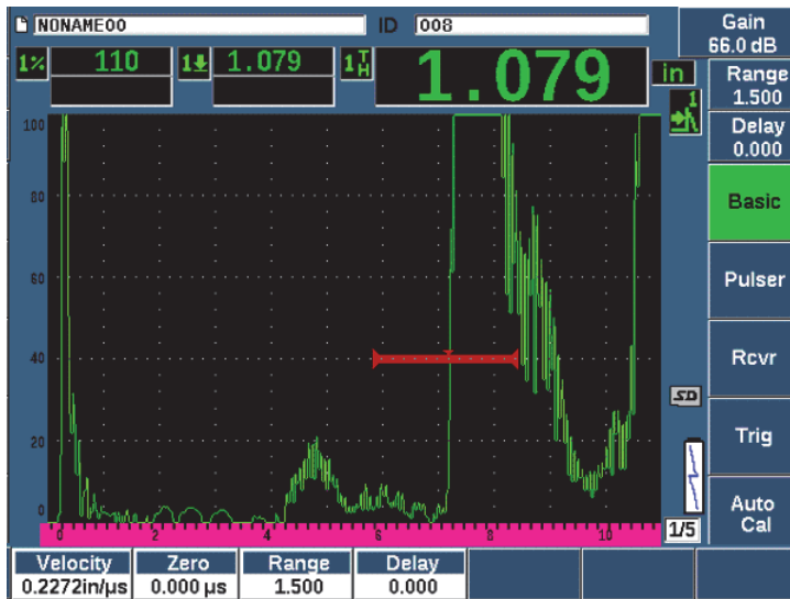
Rysunek 9-12 Przykład sygnału w bramce na potrzeby kalibracji prędkości
