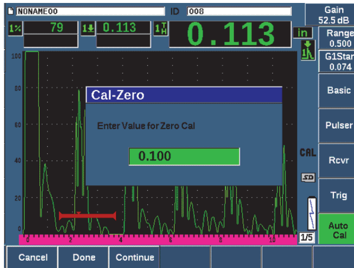
Rysunek 9-7 Wprowadzanie wartości grubości Zero Cal (Kalibracja zera)
