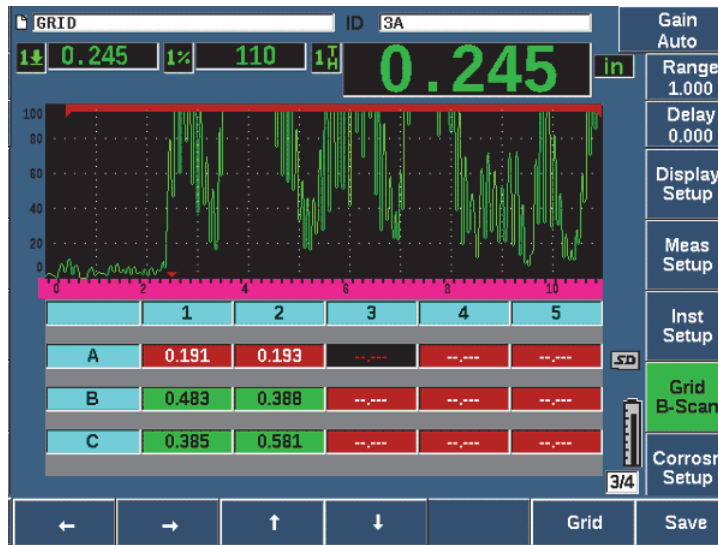
Rysunek 11-37 Widok siatki w module Corrosion Module
