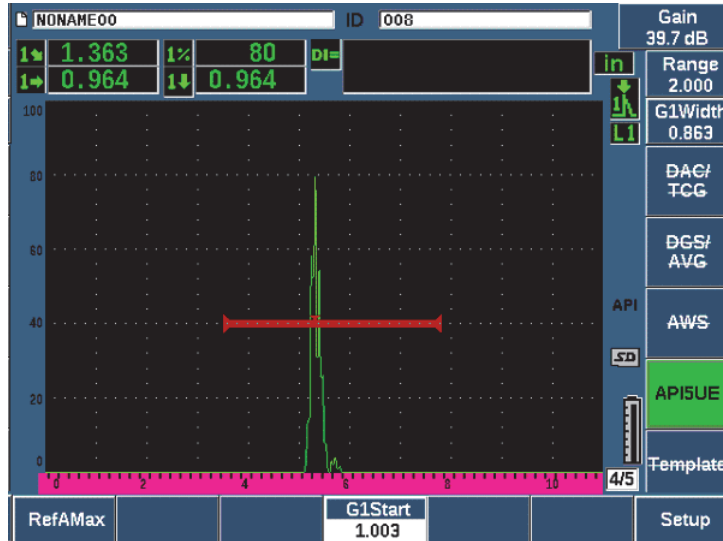
Rysunek 11-25 Zapamiętywanie punktu A_{\max}
