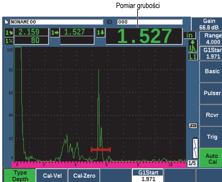
Rysunek 9-26 Przykład sygnału w bramce na potrzeby kalibracji zera
