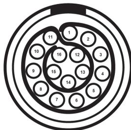
**Figura 8-1 Conector de entrada y salida (I/O) LEMO (lado de la soldadura)**
