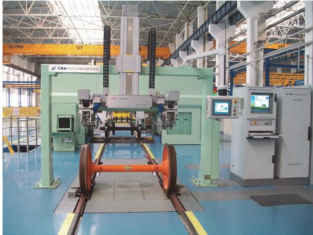
**Figura i-1 Ejemplo de un sistema completo de inspección automatizada<sup>1</sup>**
