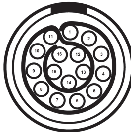
Figure 8-1 Connecteur d'entrées/sorties LEMO (côté broches)
