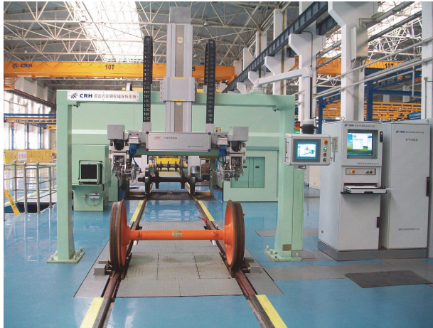
Figura i-1 Exemplo de um sistema de inspeção completamente automatizado 1
