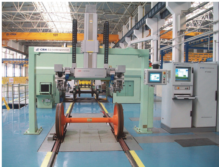
図 i-1 完全自動検査システムの例 1
