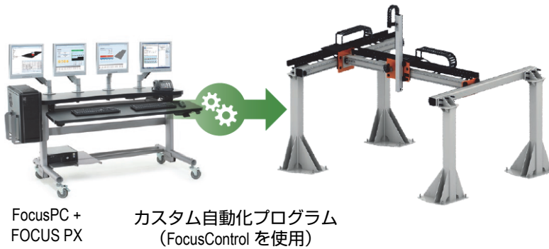
図 i-4 FocusControl を使用して自動化を有効にしたシステムの例
