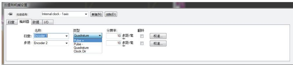
图 5-12 在编码器选项卡中选择编码器类型
