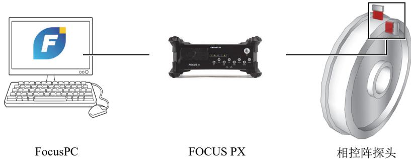
图 i-2 FocusPC / FOCUS PX系统的示例
