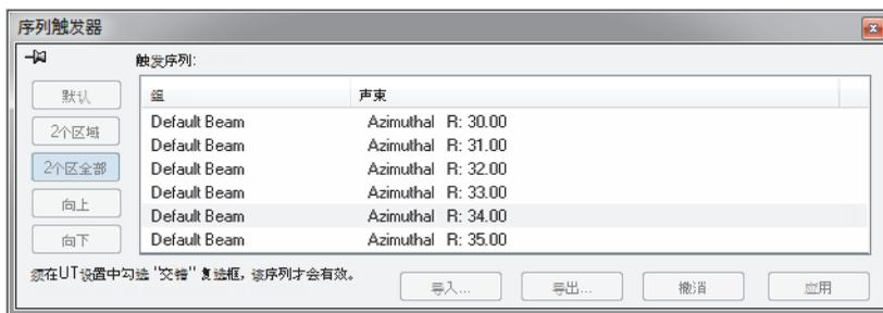
图 4-52 2个区全部成对交错的发射序列示例
