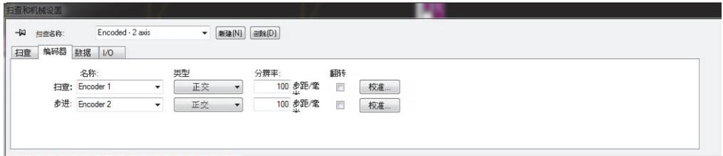
图 5-14 扫查和机械设置对话框中的编码器选项卡：编码 - 2轴扫查类型
