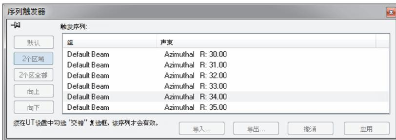
图 4-51 2个区域成对交错的发射序列示例
