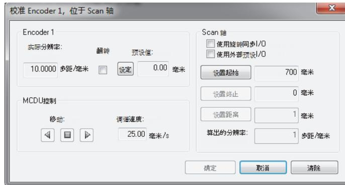
图 5-15 扫查轴上编码器1的编码器校准对话框
