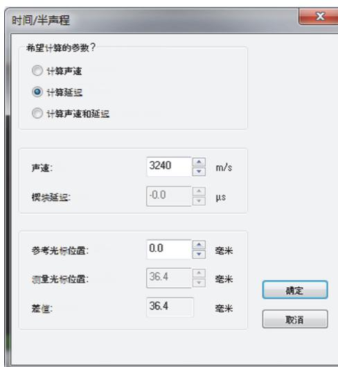
图 4-26 使用时间/半声程对话框进行校准
