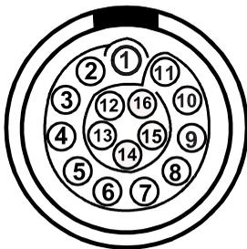
图 7-3 扫查器适配器 LEMO 连接器（焊接面）
