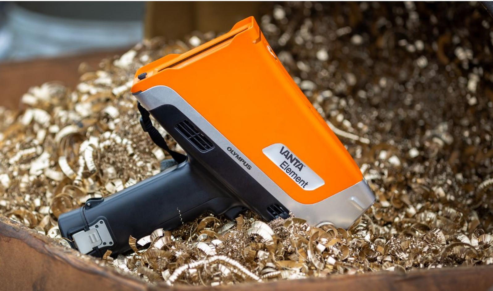
Die Serie der Vanta Element RFA-Handanalysatoren bietet eine Elementanalyse zur schnellen Identifikation und Sortierung von Legierungen zu einem erschwinglichen Preis. Die Serie ist in zwei kosteneffektiven Modellen verfügbar: dem Vanta Element Analysator für eine kostengünstige Legierungsidentifikation und dem Vanta Element-S Analysator für eine kostengünstige Erkennung von leichten Elementen.
