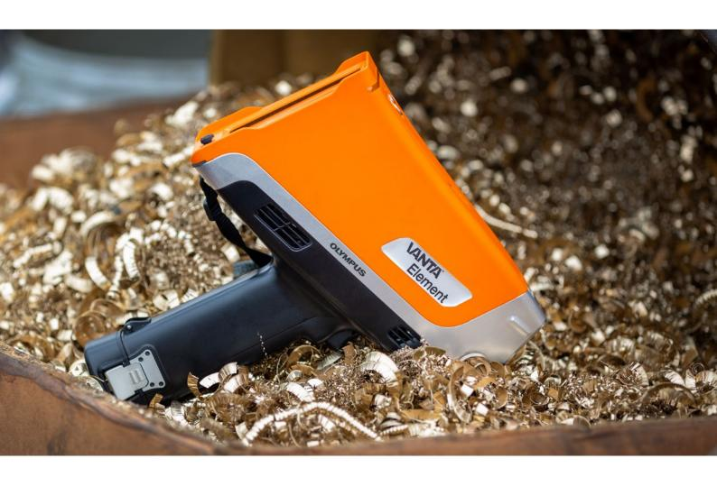
A série de analisadores portáteis por XRF Vanta Element fornece análises elementares para identificação e classificação rápidas de ligas a um preço acessível. A série está disponível em dois modelos econômicos: o analisador Vanta Element, para identificação de liga acessível, e o analisador Vanta Element-S, para detecção econômica de elementos leves.
