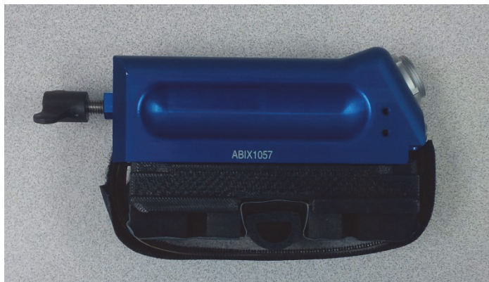
Figure 2-6 Sonde et sabot entourés de la bande autoagrippante
