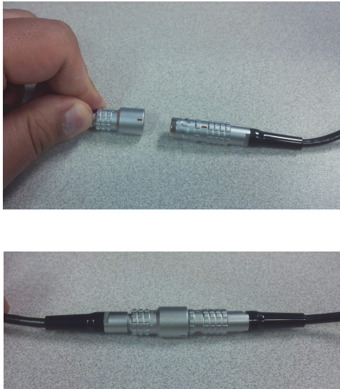
Figure 2-9 Connexion des sections du câble du codeur
