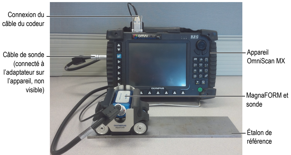
Figure 1-1 Exemple d'une configuration d'inspection
