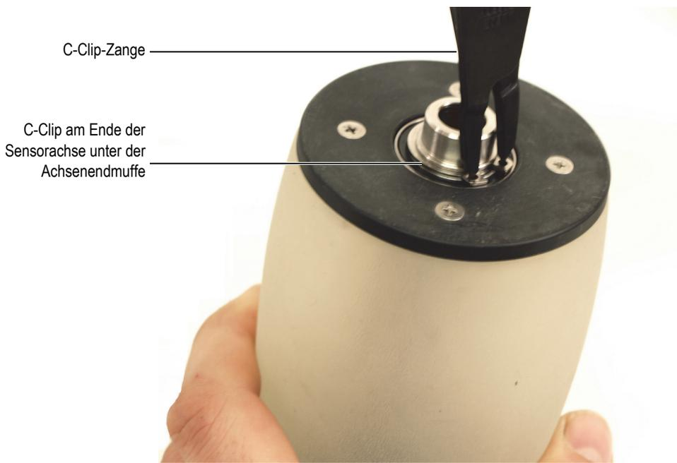
**Abbildung 6-7 Entfernen des äußeren C-Clips vom Ende der Sensorachse**
