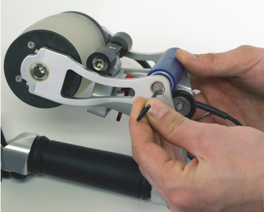
**Abbildung 6-34 Drücken der Achse aus der hinteren Rolle**
