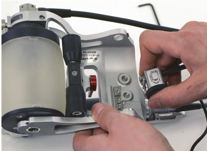
Abbildung 6-37 Entfernen des Mini-Wheel Weggebers
