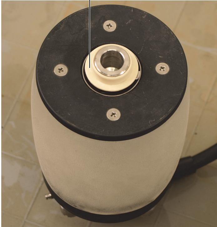
**Abbildung 6-30 Anbringen der Muffe am Ende der Sensorachse
