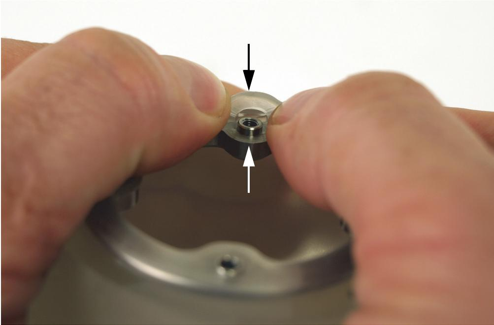
**Abbildung 6-25 Einsetzen eines Edelstahlrings in die Halterille des Rollenbelags**
