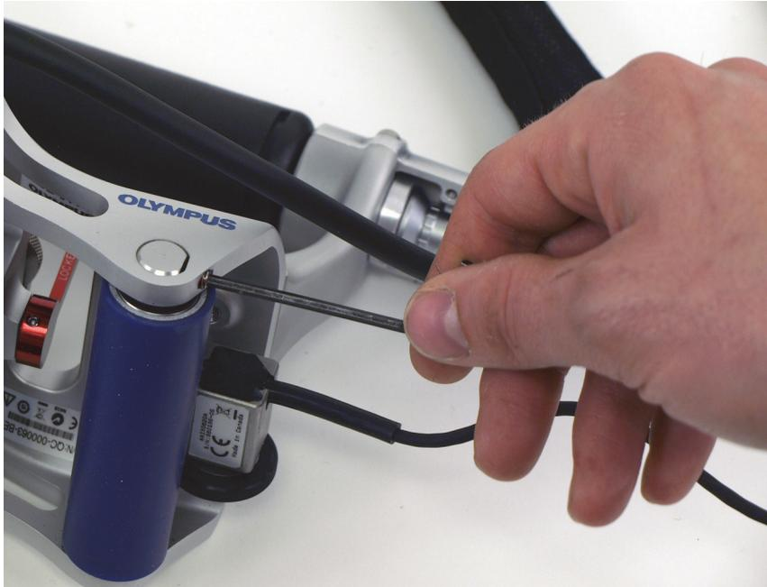
**Abbildung 6-33 Lösen der Feststellschraube der hinteren Rolle**
