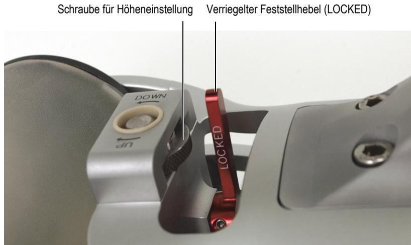
**Abbildung 4-8 Verriegeln der zwei Mittelrollen**
