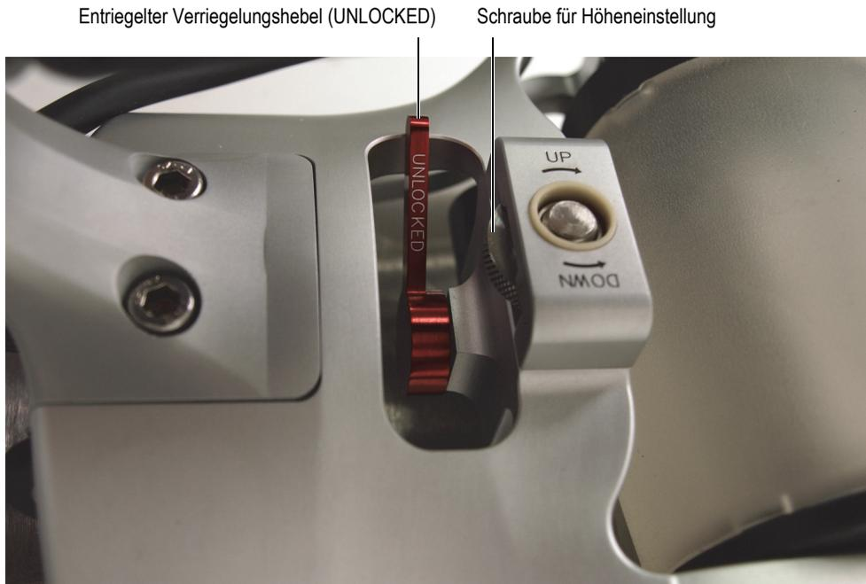
**Abbildung 4-4 Entriegeln der zwei Mittelrollen**
