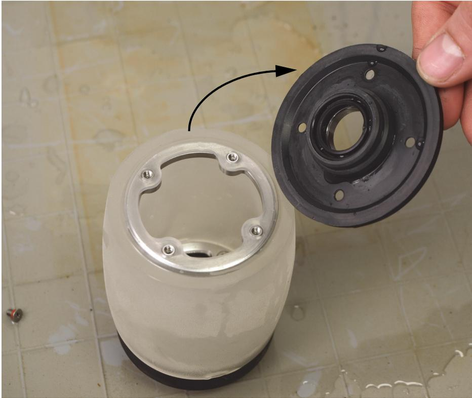
**Abbildung 6-15 Entfernen des Flachflanschs von der Akustikrolle**
