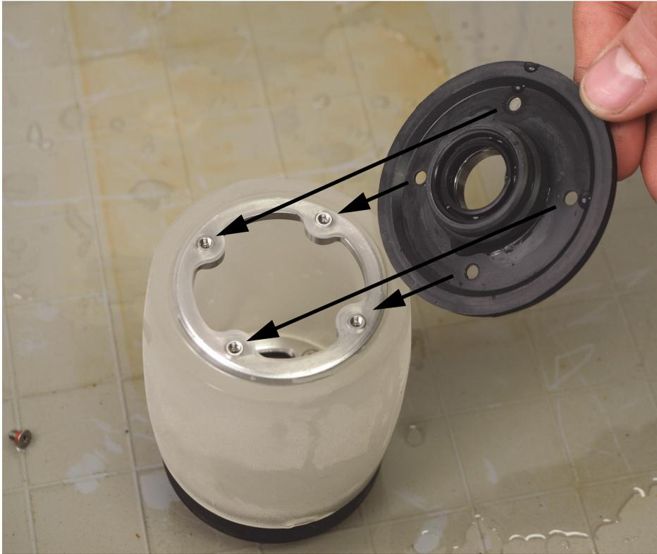
**Abbildung 6-28 Ausrichten des Flachflanschs mit den Bohrungen**
