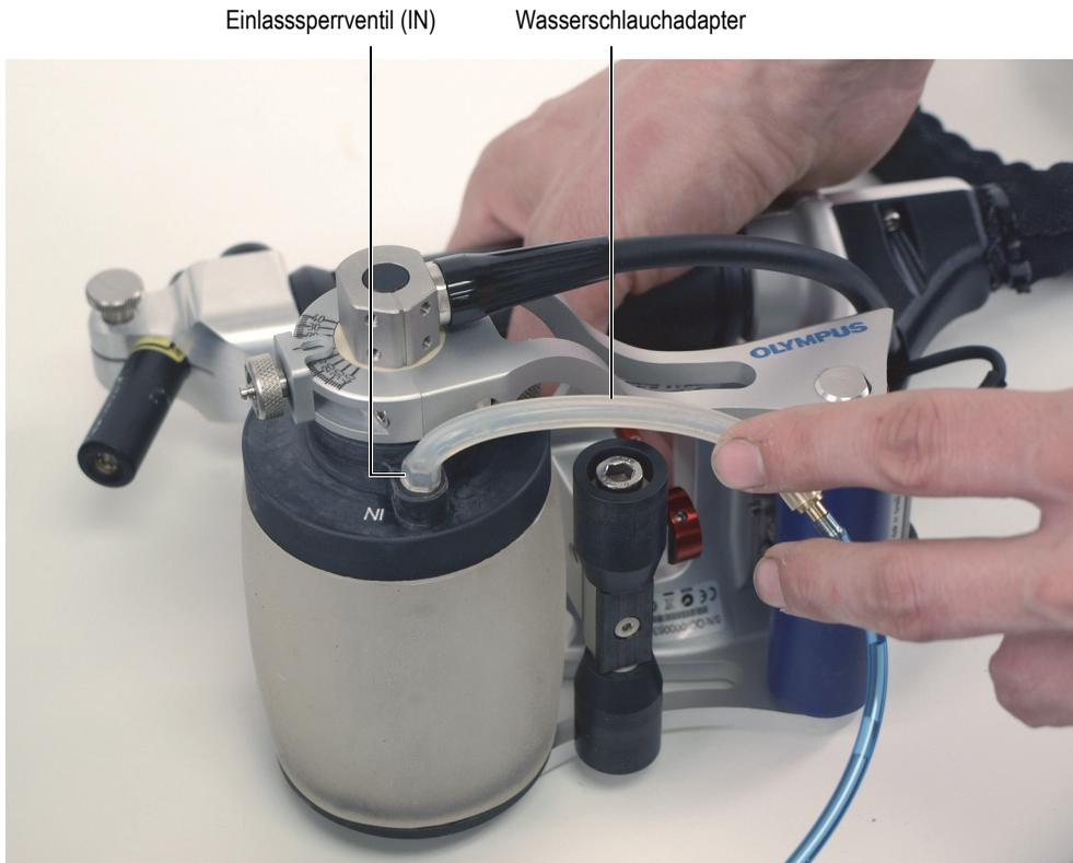
**Abbildung 3-2 Wasserschlauchadapter am Einlassventil (IN)**
