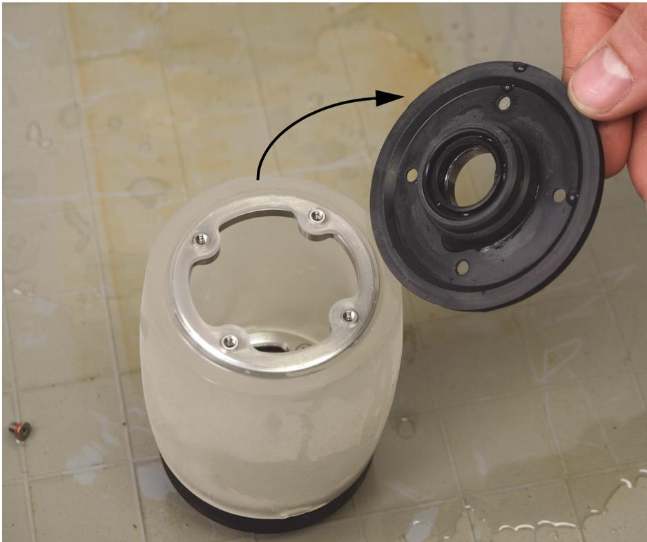
**Abbildung 6-17 Entfernen des Flachflanschs von der Akustikrolle**
