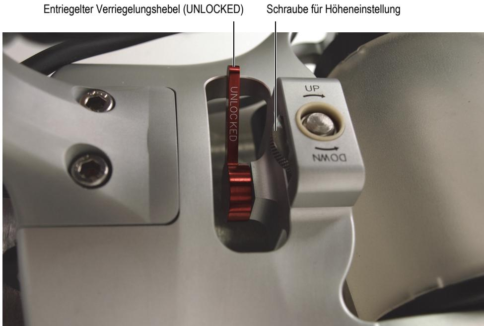
**Abbildung 4-5 Entriegeln der zwei Mittelrollen**
