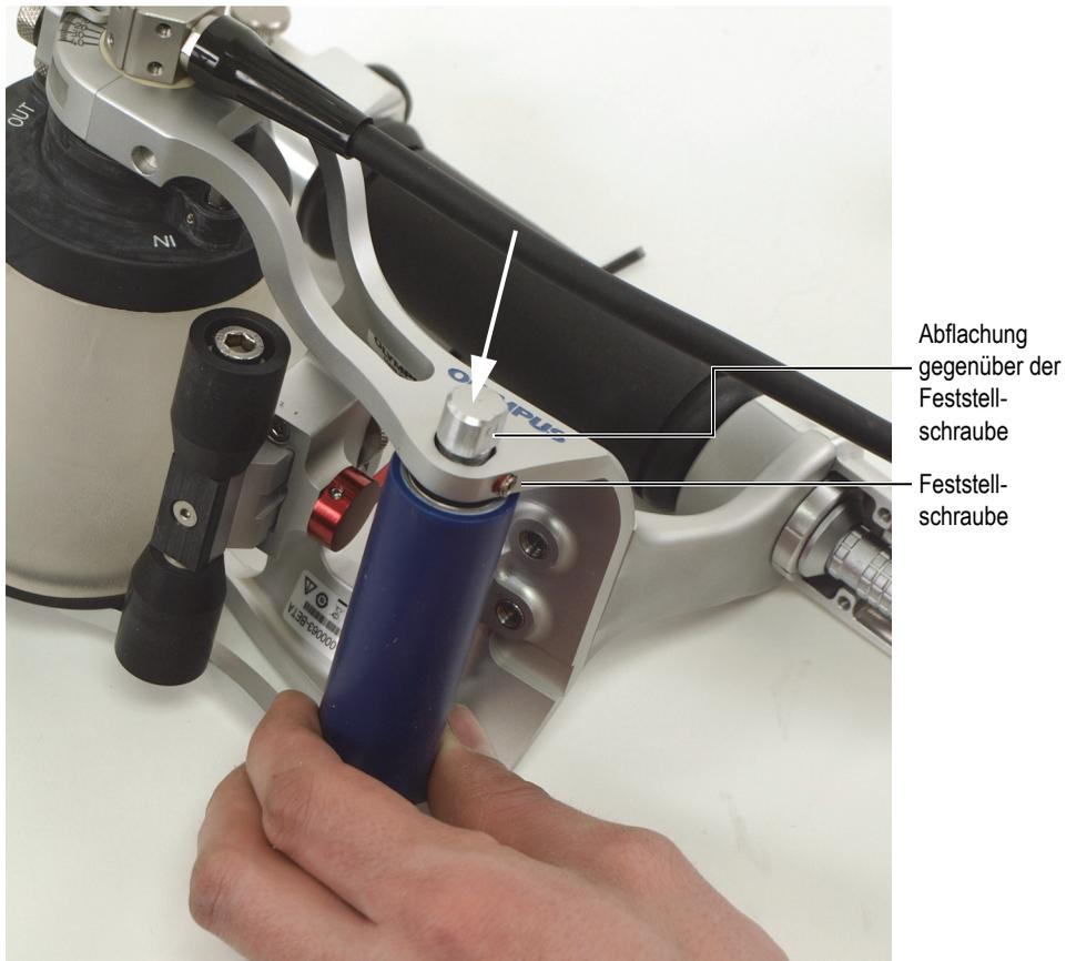
**Abbildung 6-38 Ausrichten der Abflachung der Achse der hinteren Rolle mit der Feststellschraube**
