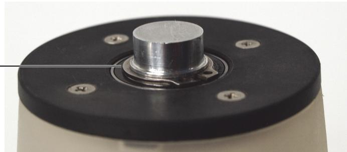
**Abbildung 6-12 Herunterdrücken des C-Clips in die Rille am Sensorachsenende mit dem Hilfswerkzeug**
