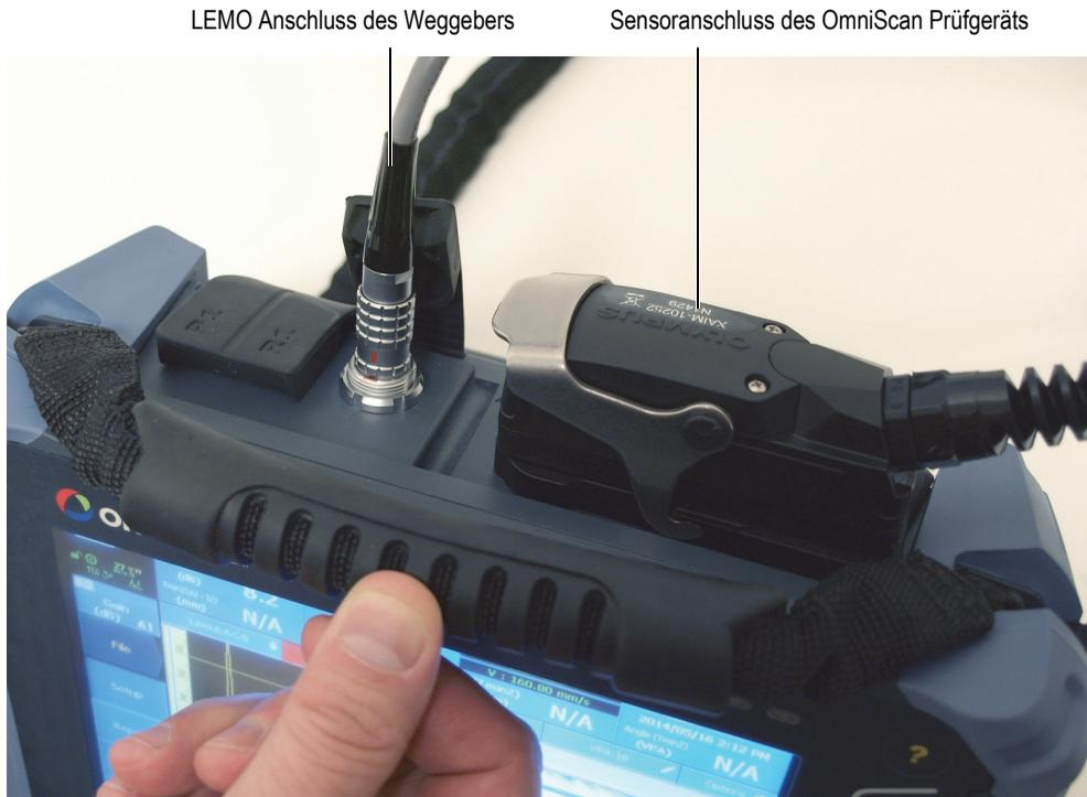
**Abbildung 2-1 OmniScan Prüfgerät mit angeschlossenen RollerFORM Kabeln**
