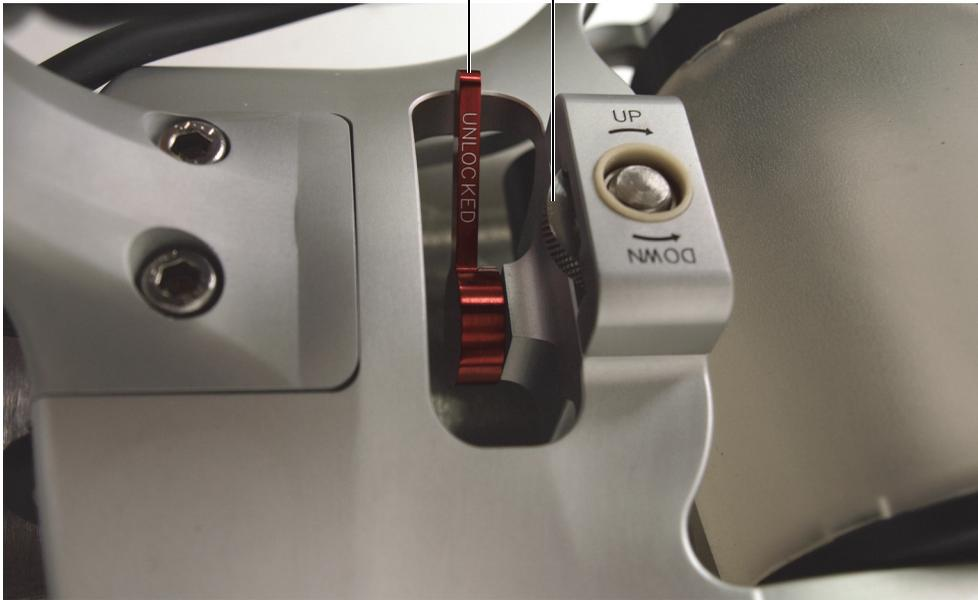
**Abbildung 4-2 Entriegeln der zwei Mittelrollen**
