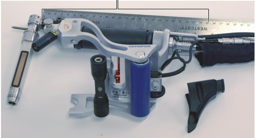
**Abbildung 6-13** Sensor-Kabel vom vorderen bis zum hinteren Ende des RollerFORM Griffs
