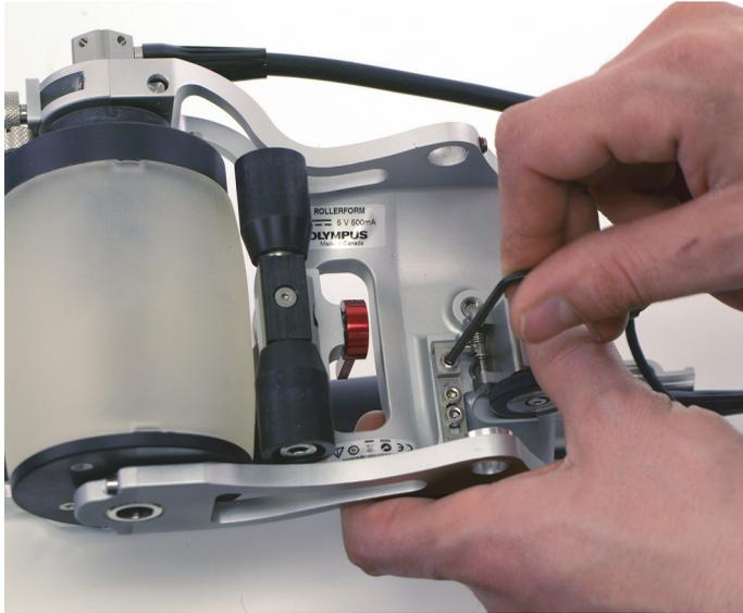
**Abbildung 6-36 Lösen der Feststellschraube des Mini-Wheel Weggebers**
