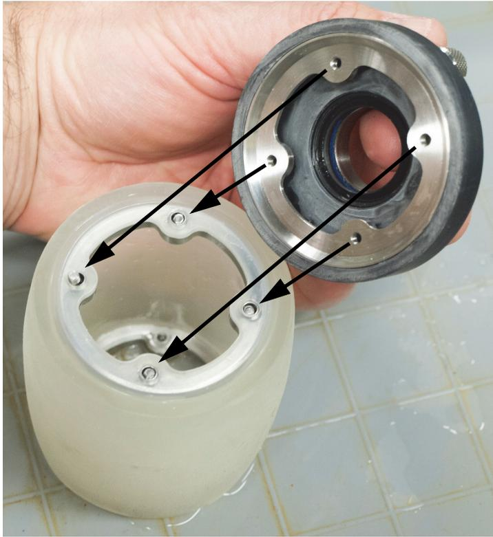
**Figura 6-26 Instalación de la pestaña con las válvulas de control de líquidos**
