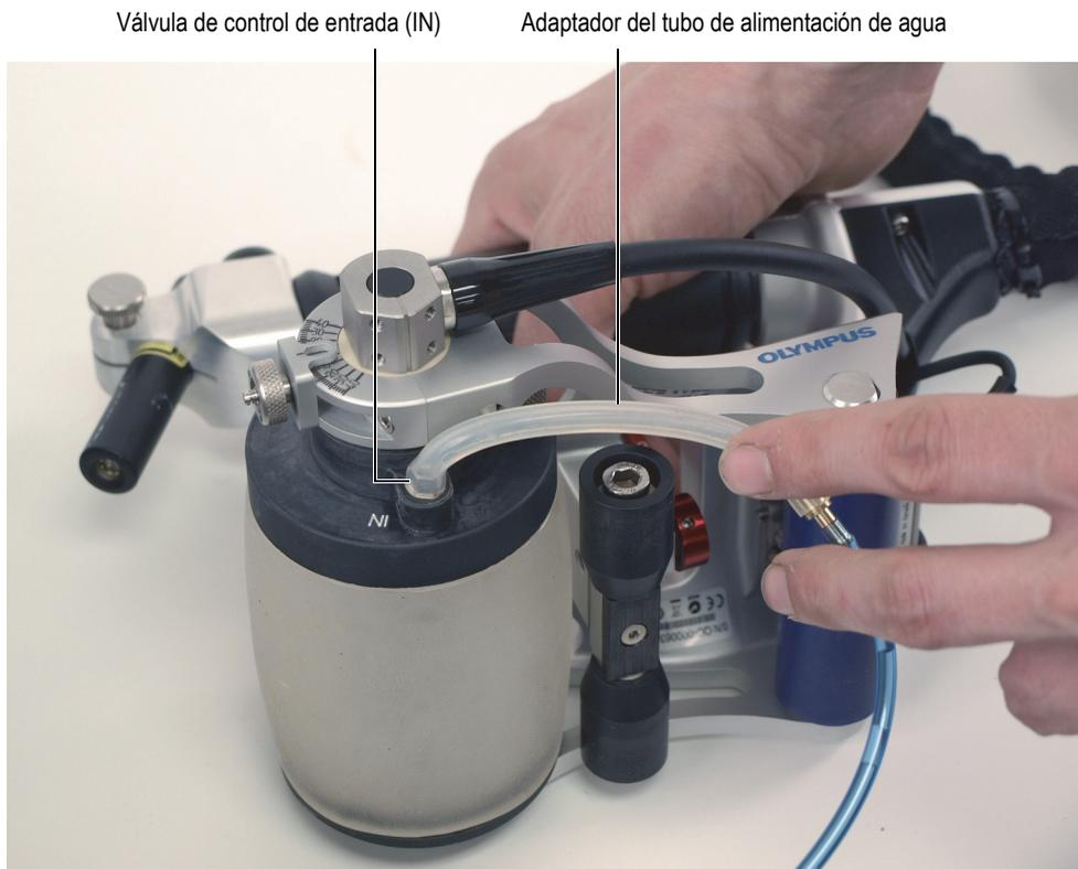
**Figura 3-2 Conexión del adaptador del tubo de alimentación de agua a la válvula de control de entrada (IN)**
