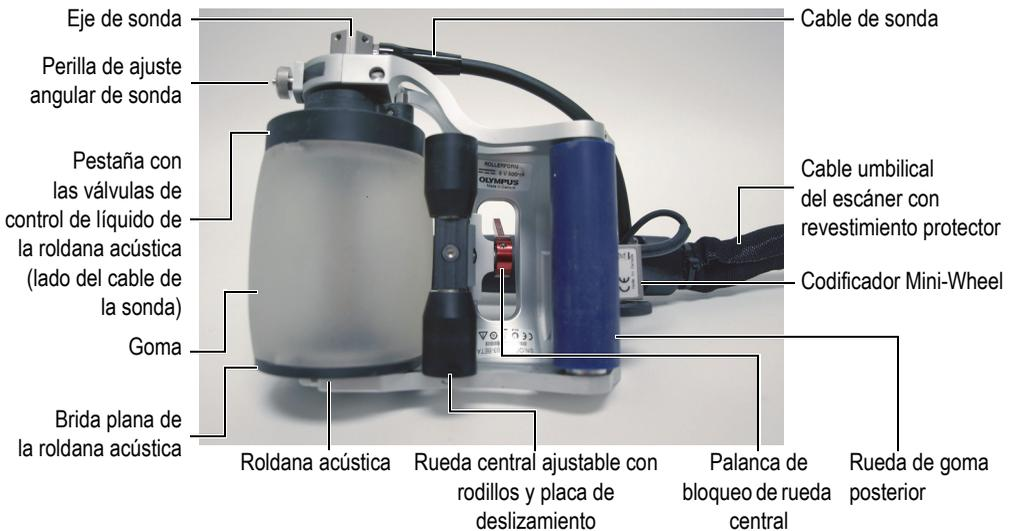
**Figura 1-4 Vista de la parte inferior del RollerFORM: visualización de los tres sistemas de rodamiento y codificador**
