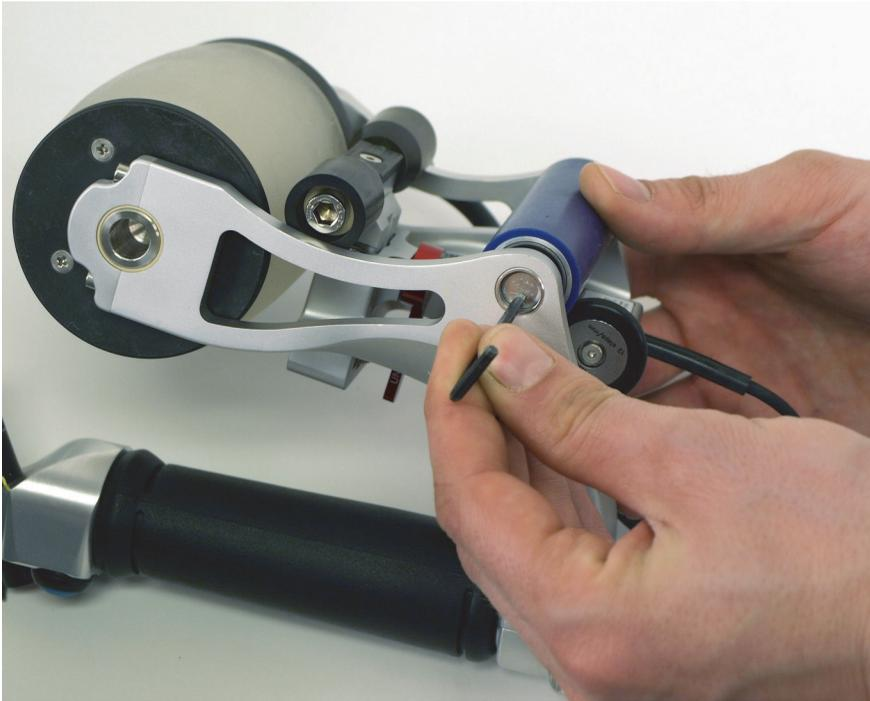
**Figura 6-34 Empuje sobre el eje de la rueda de goma posterior para retirarlo de su emplazamiento**
