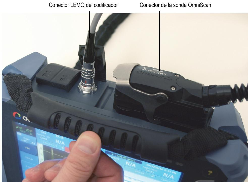
**Figura 2-1 Cables del escáner RollerFORM conectados a un equipo OmniScan**
