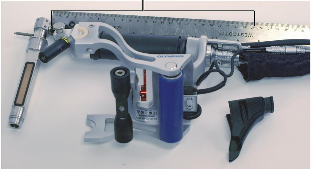
**Figura 6-13 Cable de la sonda extendido desde la parte frontal hasta la parte posterior de la empuñadura del escáner RollerFORM**
