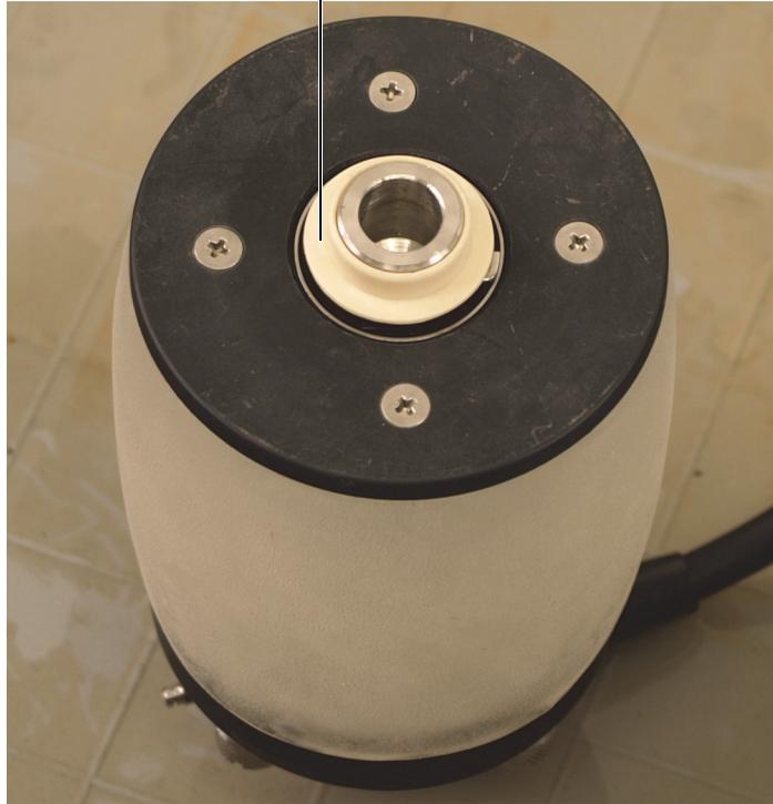
**Figura 6-30 Instalación del casquillo al final del eje de la sonda
