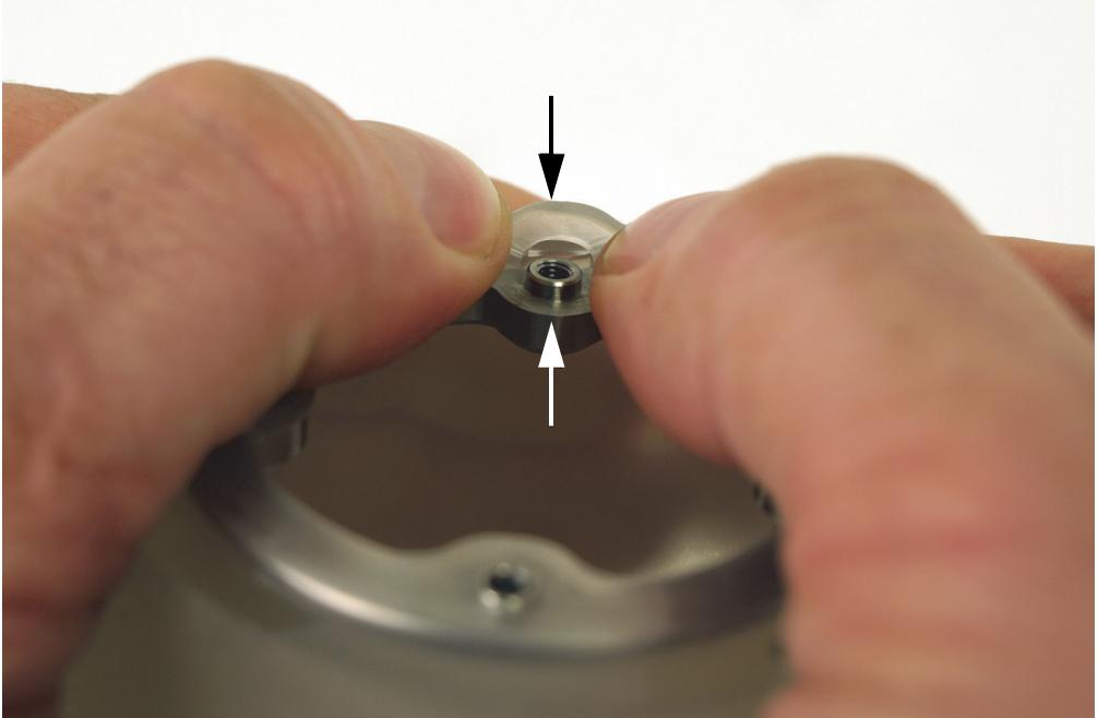
**Figura 6-25 Instalación de un anillo en las muescas de retención de la goma**
