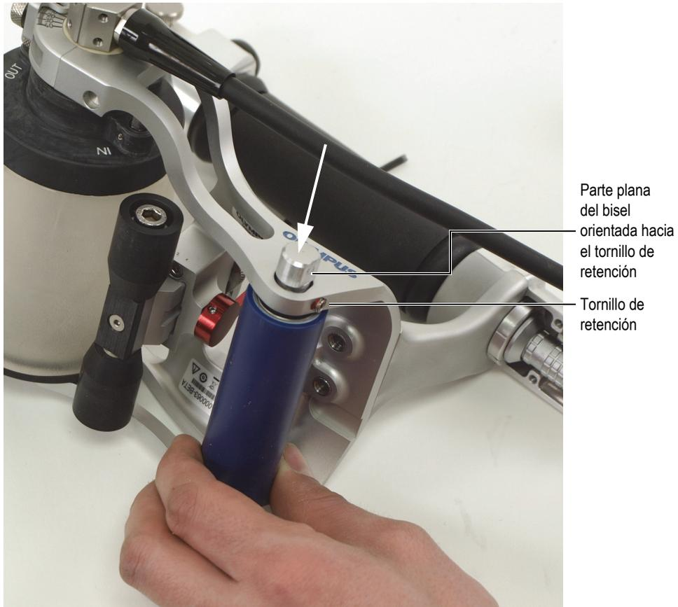
**Figura 6-38 Alineación de la parte plana del bisel, al final del eje de la rueda de goma posterior, con los tornillos de retención**
