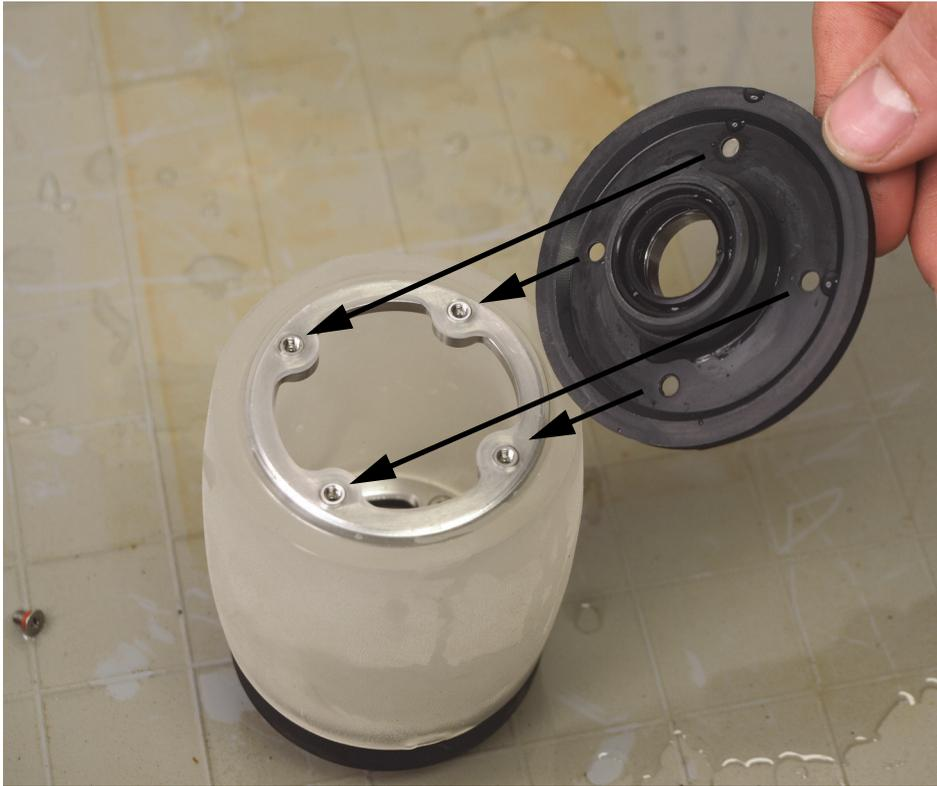
**Figura 6-28 Instalación de la brida plana**
