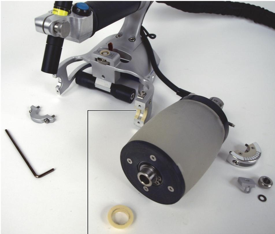
Emplazamiento de la rueda acústica (lado sonda-cable) con dos medios casquillos (el modelo de escáner XL no tienen casquillos.)
