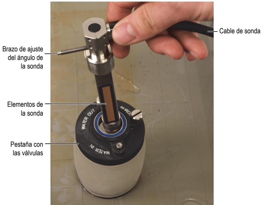
**Figura 6-9 Instalación del eje de la sonda dentro de la roldana acústica**
