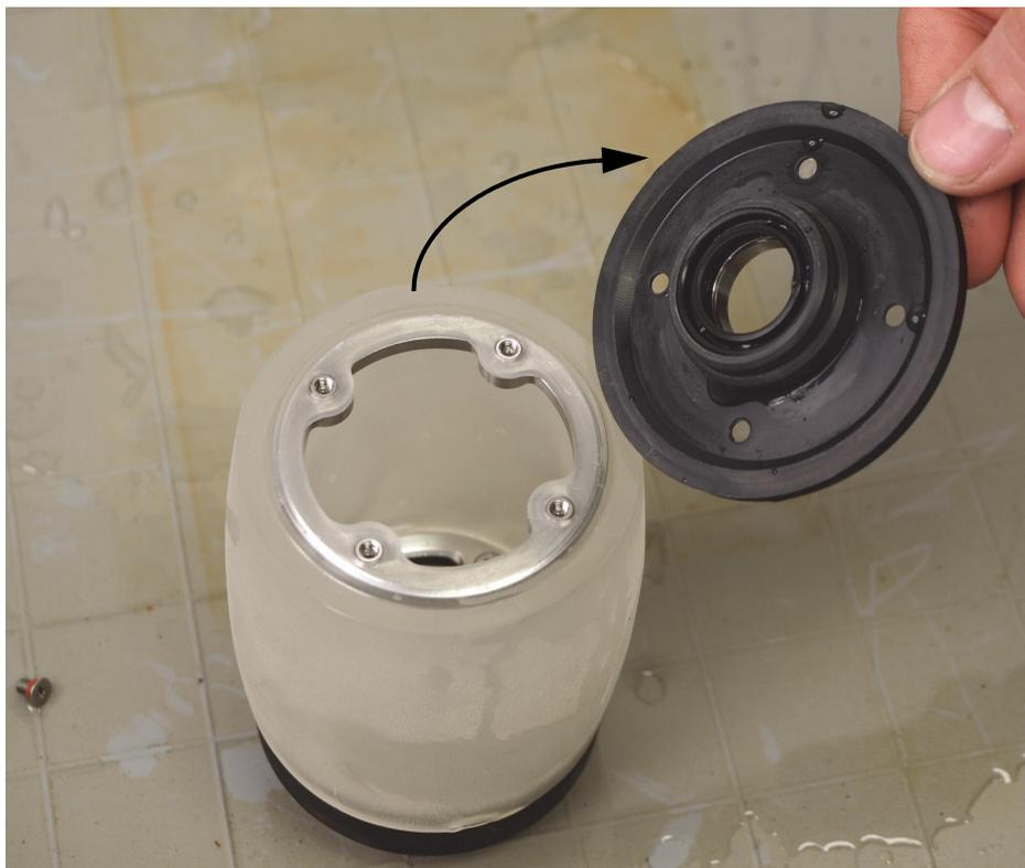
**Figura 6-15 Extracción de la brida plana de la roldana acústica**
