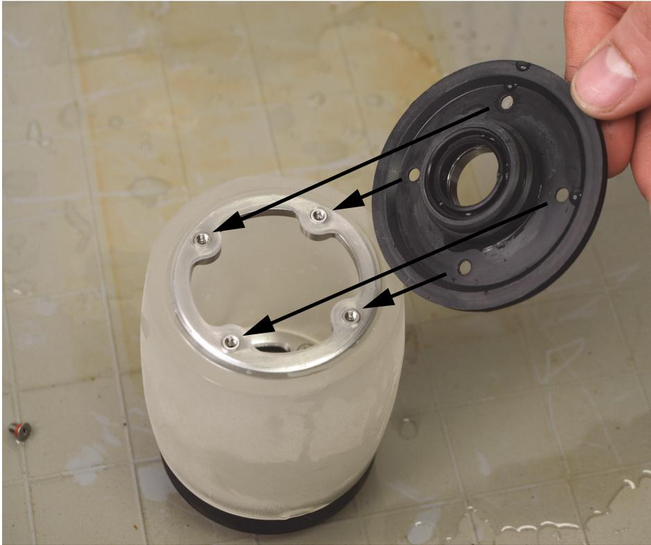
**Figura 6-16 Instalación de la brida plana**
