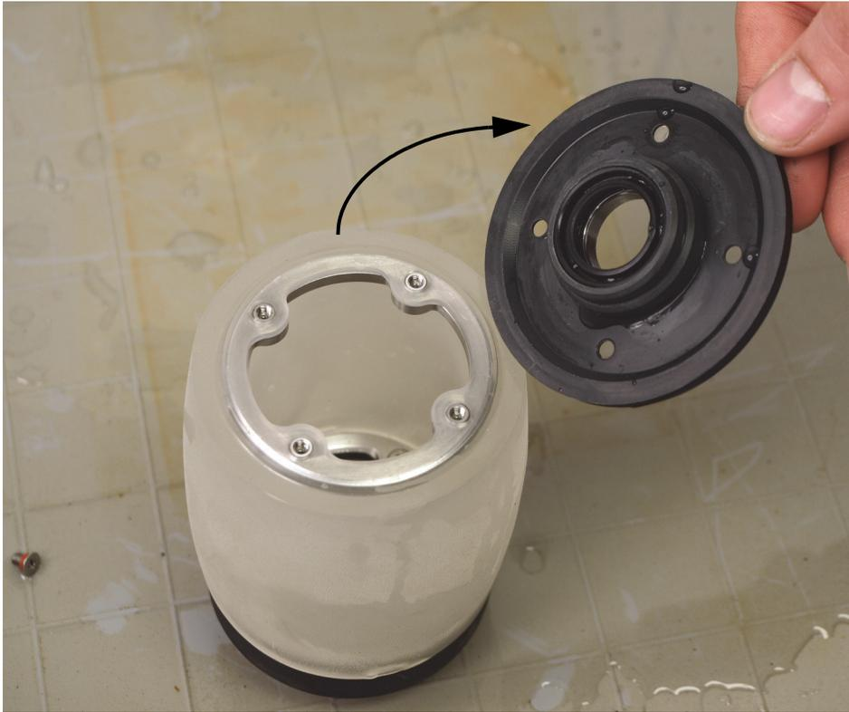
**Figura 6-20 Extracción de la brida plana de la roldana acústica**
