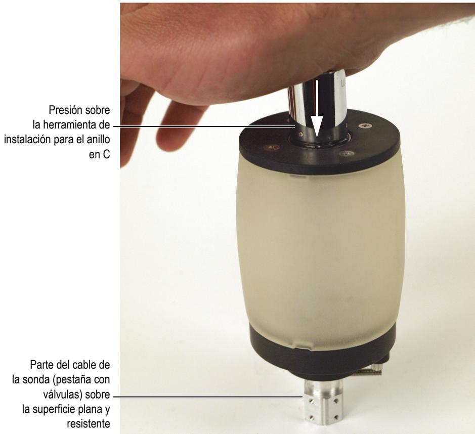
**Figura 6-11 Presión del anillo en C hacia la muesca (al extremo del eje de sonda) gracias a la herramienta de instalación para anillos en C**
