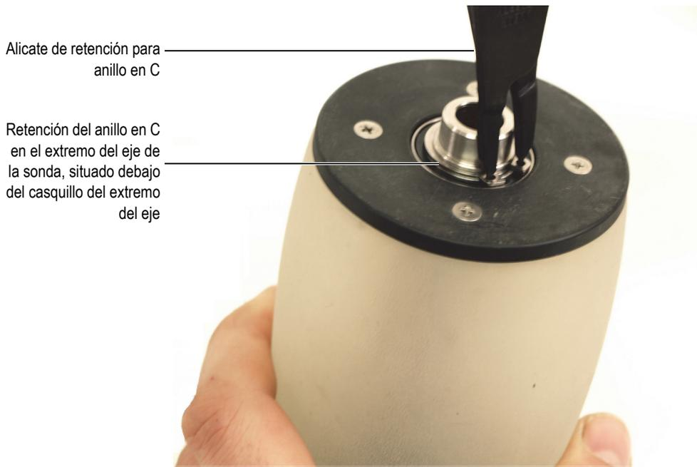
**Figura 6-7 Extracción del anillo de retención en C externo desde el extremo del eje de sonda**
