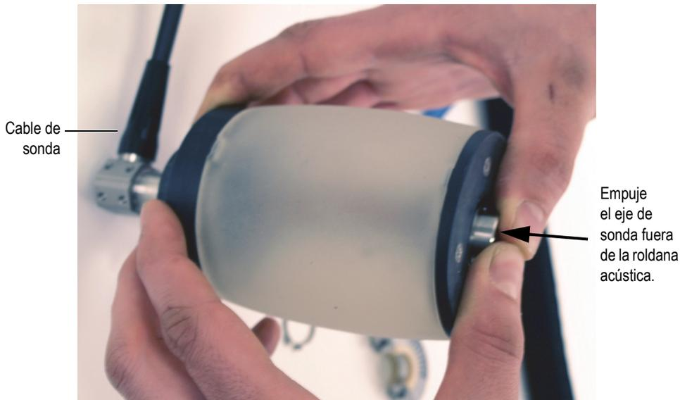
**Figura 6-8 Empuje del eje de sonda fuera de la roldana acústica**
