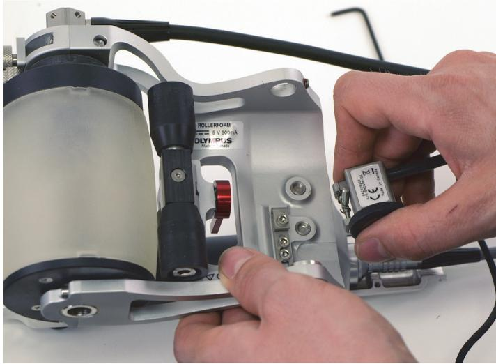
图 6-37 取下Mini-Wheel（袖珍轮）编码器
