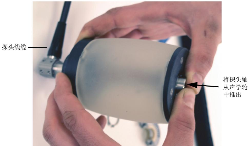
图 6-8 将探头轴从声学轮中推出
