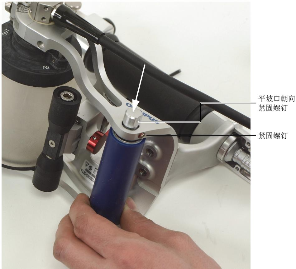
图 6-38 将后部滚轮轴端的平坡口与紧固螺钉对齐
