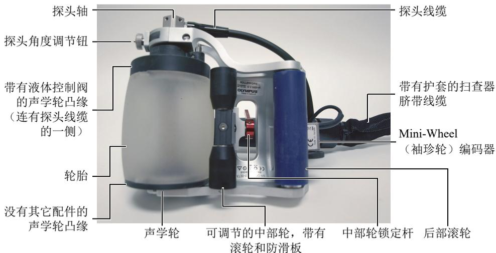
图 1-4 RollerFORM扫查器的底面，显示了3个轮子系统和编码器
