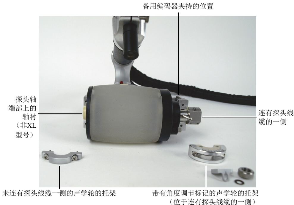
**图 6-31 安装声学轮的托架**
