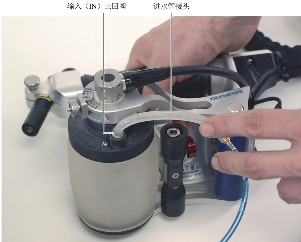
图 3-2 将进水管接头连接到输入 (IN) 止回阀上
