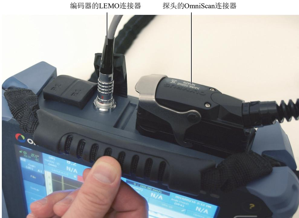
图 2-1 连接有RollerFORM线缆的OmniScan仪器
