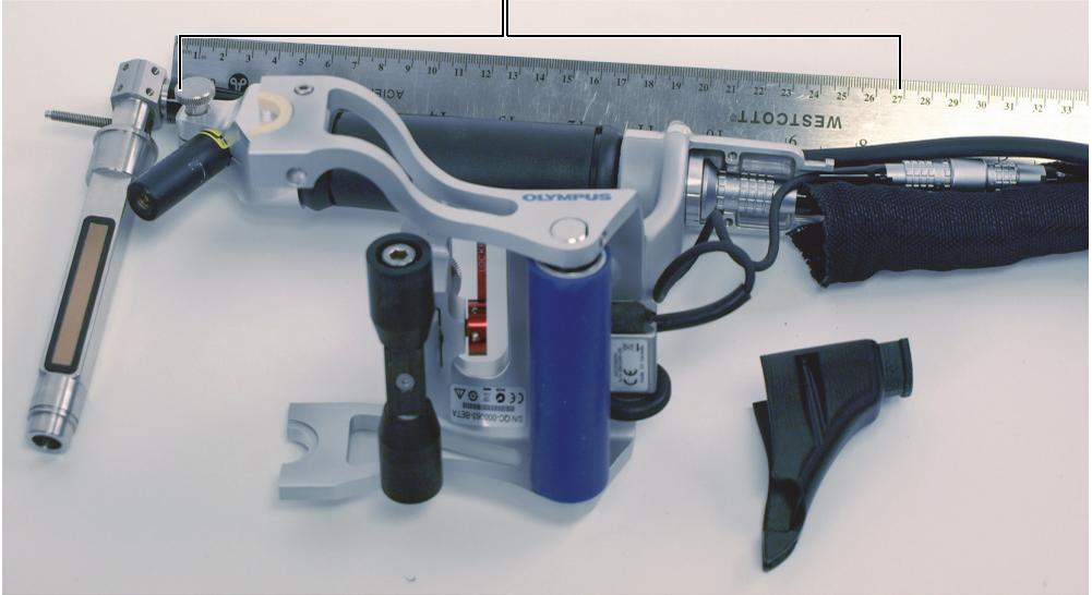
图 6-13 从RollerFORM扫查器手柄的前部延伸到后部的探头线缆
