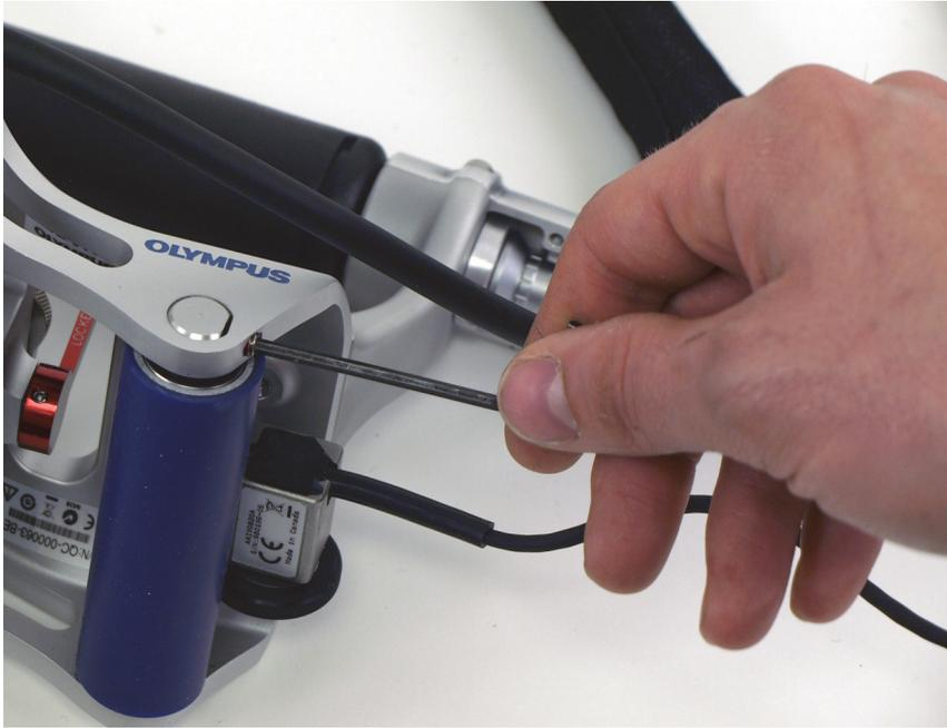
图 6-33 松开后部滚轮上的紧固螺钉
