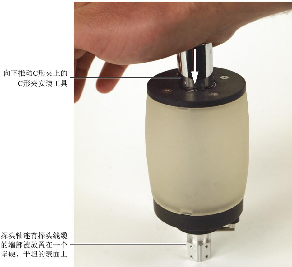
**图 6-11 使用C形夹安装工具将C形夹推进到探头轴端部的凹槽中**
