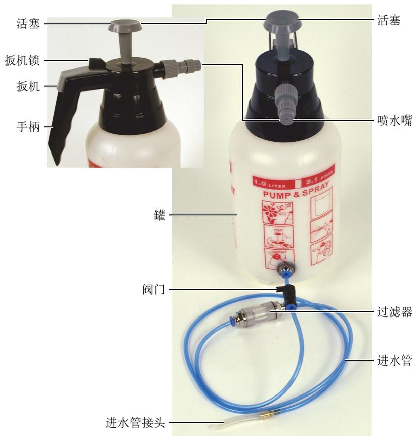
图 1-5 1.0升手动泵和进水管
