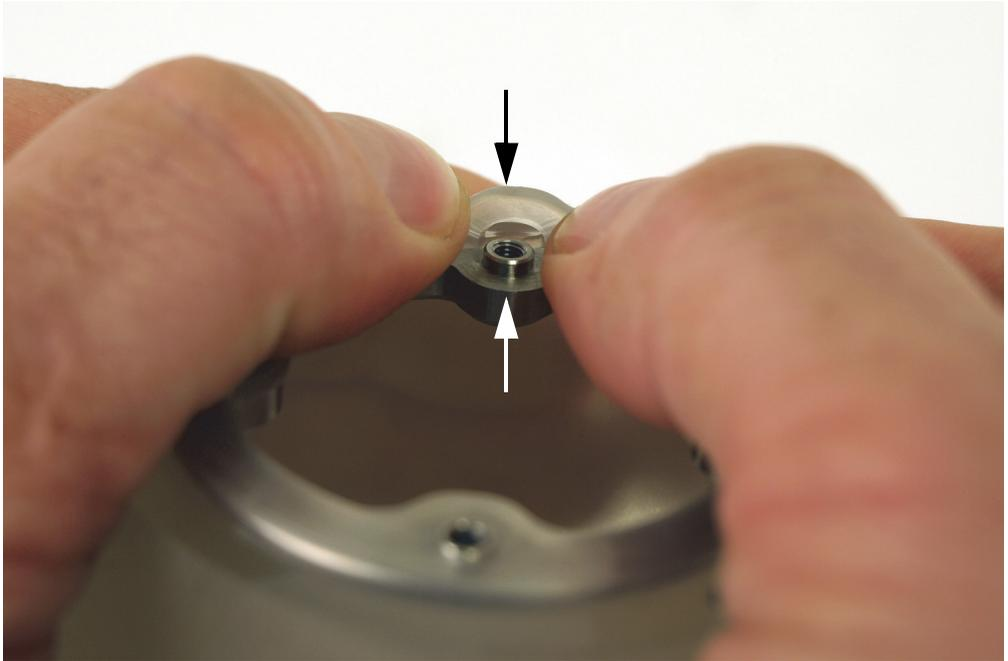
图 6-25 在轮胎的紧固凹槽中安装环
