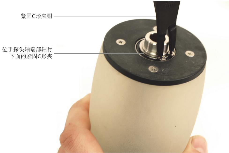
图 6-7 取下探头轴端部的外置紧固C形夹
