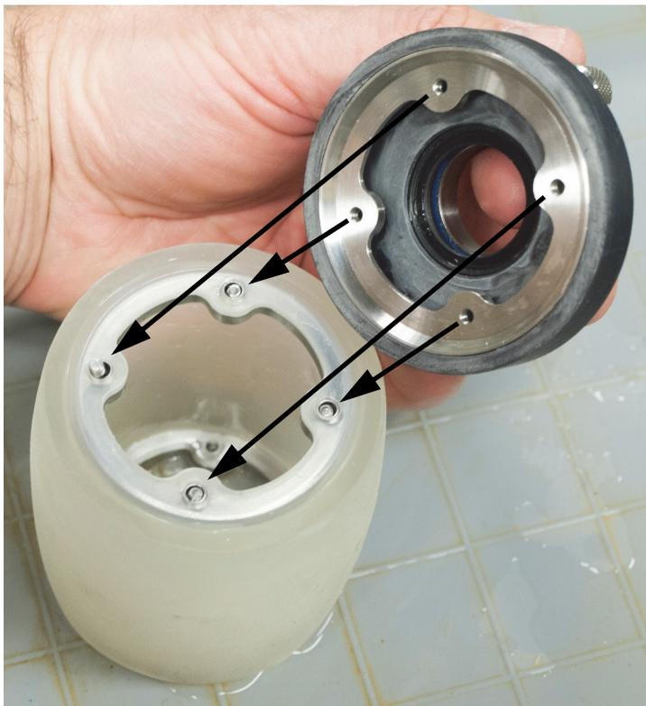
图 6-26 安装带有液体控制阀的凸缘
