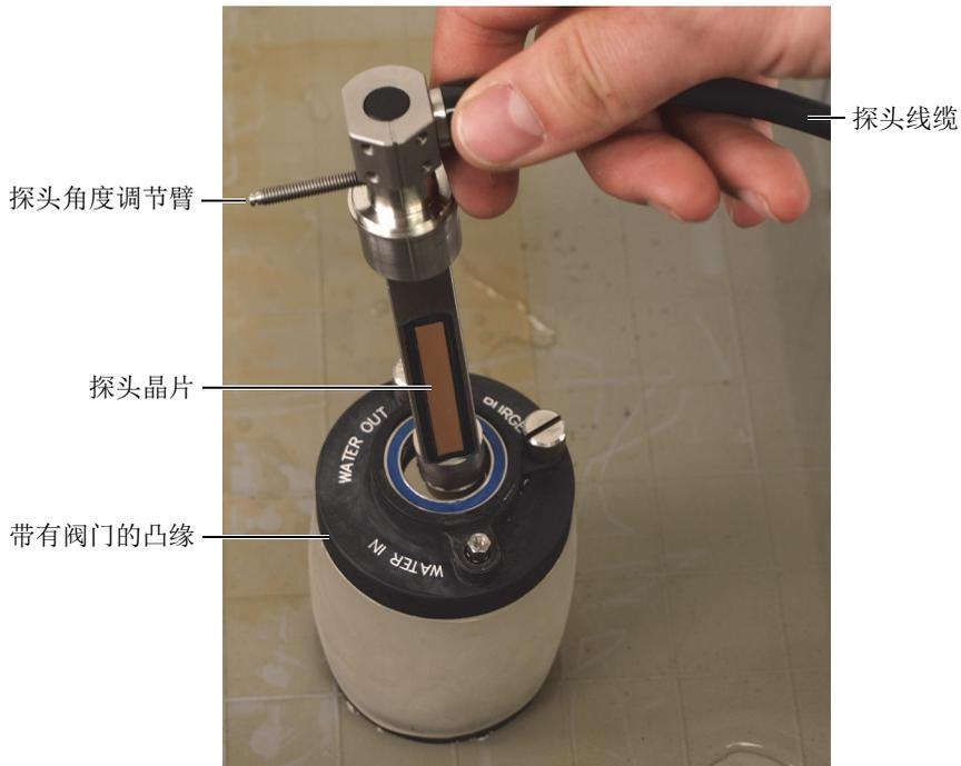
图 6-9 将探头轴插入到声学轮中
