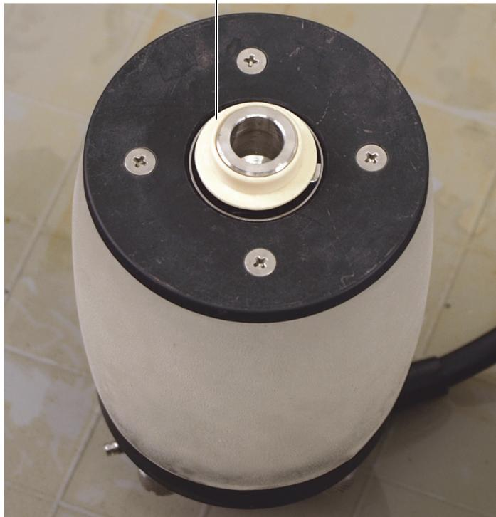
图 6-6 取下探头轴端部的轴衬（非XL型号）
