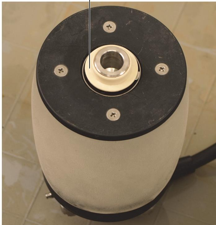
图 6-30 将轴衬安装在探头轴的端部（非XL型号）
