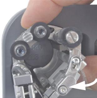
**Abbildung 2-17 Drehen der Sensorhalterung, um die Position für Außendurchmesser unter 33,4 mm einzustellen**
