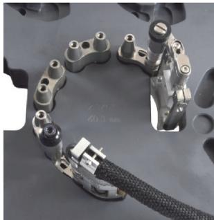
**Abbildung 2-14 Einsetzen der Verbindungsglieder mit Stift**
