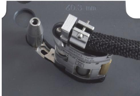
**Abbildung 2-8 Endstück in seiner Vertiefung in der Schablone**
