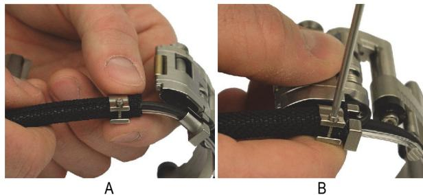
**Abbildung 2-3 Befestigen der Schlauchschelle**
