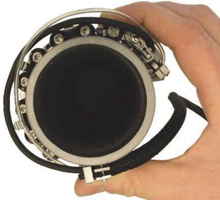
**Abbildung 2-24 Legen und Halten des Scanners um das Rohr**
