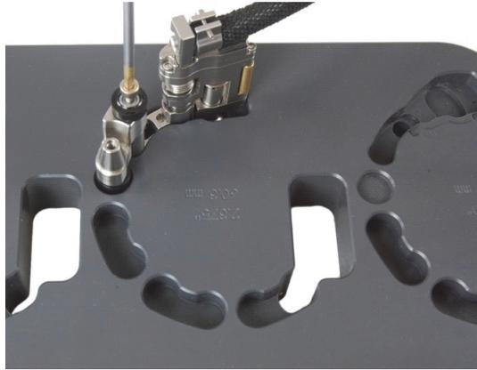
**Abbildung 2-11 Befestigen eines halben Verbindungsglieds**
