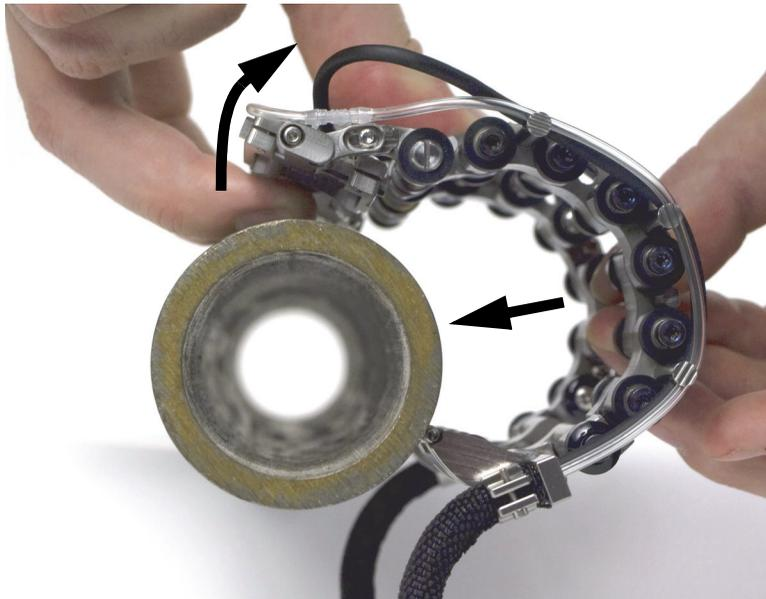
Abbildung 2-28 Befestigen des Scanners auf dem Rohr
