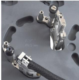
**Abbildung 2-13 Einsetzen der Sensorhalterung in die Einrichtungsschablone**
