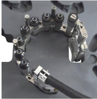
**Abbildung 2-15 Einsetzen der Verbindungsglieder mit Loch oder der mittelgroßen Verbindungsglieder**
