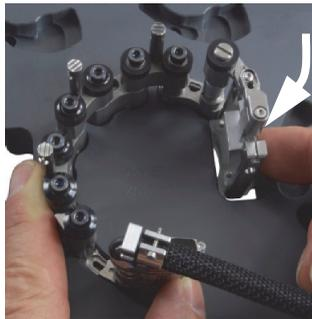
**Abbildung 2-16 Drehen der Sensorhalterung, um die Position für Außendurchmesser über 33,4 mm einzustellen**
