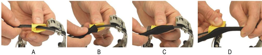
**Abbildung 2-2 Befestigen der Schutzhülle**
