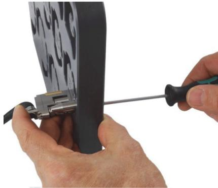
**Abbildung 2-9 Festschrauben der Endstückstellschraube**
