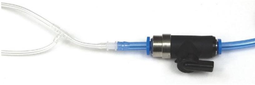
**Abbildung 2-29 Koppelmittelventil (geöffnet)**
