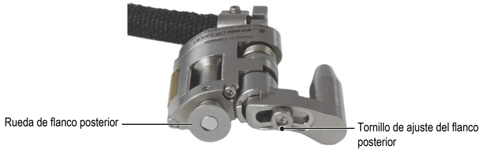
Figura 2-7 Tornillo de ajuste del flanco posterior
