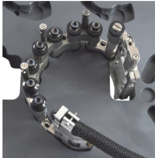
Figura 2-15 Instalación de enlaces hembras o medios
