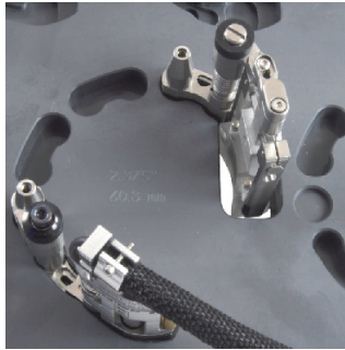
Figura 2-13 Instalación de un soporte de sonda en la plantilla de configuración
