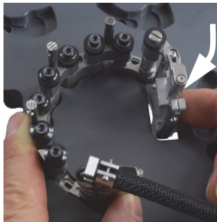
Figura 2-16 Rotación del soporte de sonda para determinar la posición del diámetro externo superior a 33,4 mm (1,315 pulg.)
