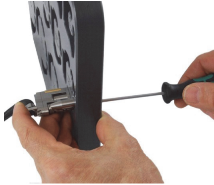
Figura 2-9 Fijación del tornillo de ajuste del flanco posterior
