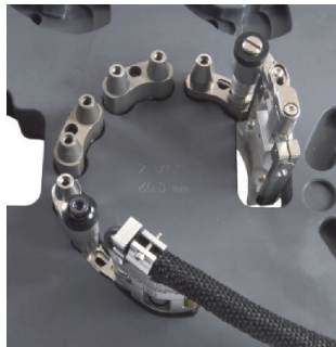
Figura 2-14 Instalación de enlaces machos
