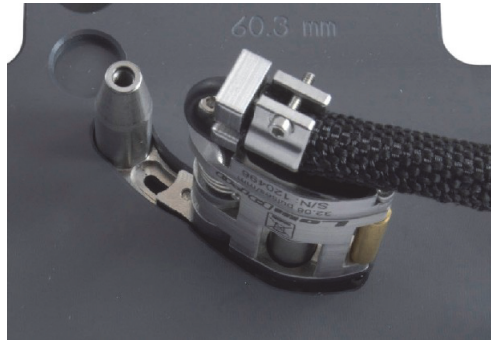
Figura 2-8 Introducción del flanco posterior en el molde de la plantilla de configuración
