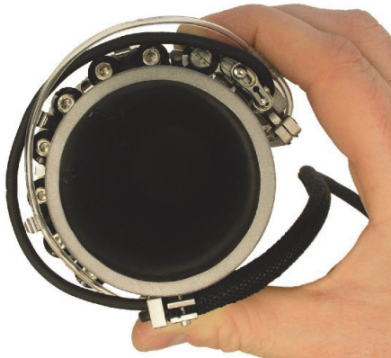
Figure 2-24 Scanner plié et maintenu autour du tuyau
