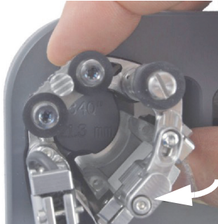
Figure 2-17 Rotation du support de sonde pour régler la position des diamètres extérieurs inférieurs à 33,4 mm
