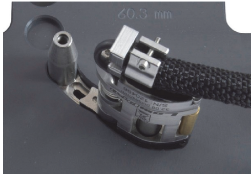
Figure 2-8 Insertion de la queue dans le trou correspondant du gabarit
