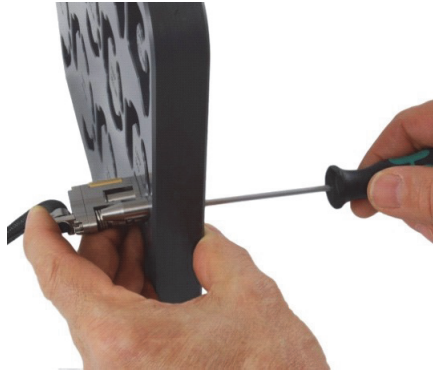
Figure 2-9 Serrage de la vis de réglage de la queue
