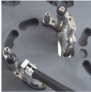
Figure 2-13 Installation du support de sonde sur le gabarit
