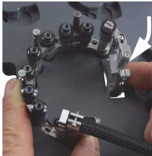
Figure 2-16 Rotation du support de sonde pour régler la position pour les diamètres extérieurs supérieurs à 33,4 mm
