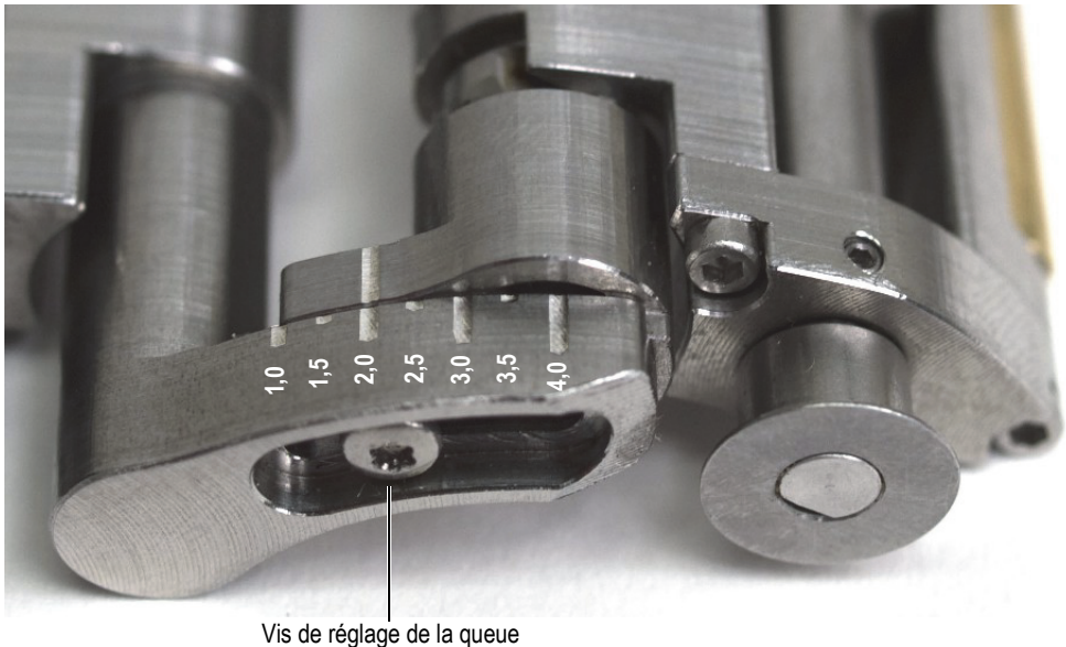
Figure 2-22 Exemple de queue configurée à la position 2.0
