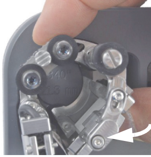
Figura 2-17 Rotazione del supporto della sonda per regolare la posizione per i diametri esterni superiori a 33,4 mm
