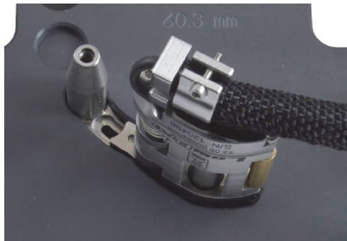
Figura 2-8 Inserimento della coda nel foro di alloggiamento corrispondente della dima di configurazione
