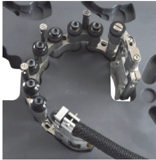
Figura 2-15 Instalar as conexões fêmea e/ou média
