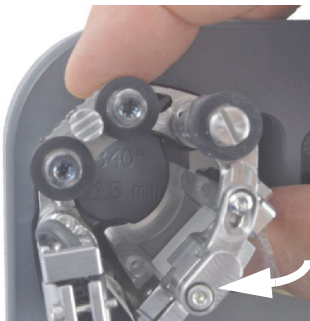
Figura 2-17 Girar o suporte da sonda para definir a posição para diâmetros externos menores que 33,4 mm
