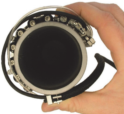
Figura 2-24 Envolver e segurar o escâner
