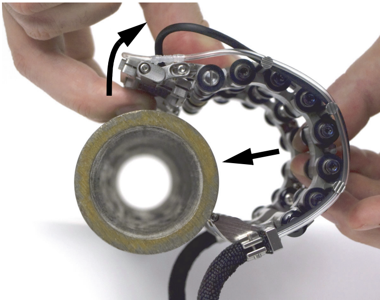
Рис. 2-28 Установка сканера на трубе
