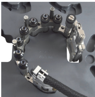
Рис. 2-15 Установка ответных и/или средних звеньев
