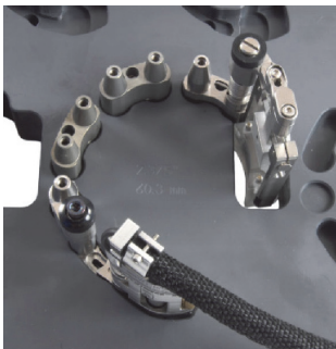
Рис. 2-14 Установка штепсельных звеньев
