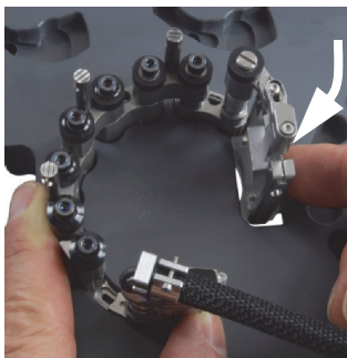
Рис. 2-16 Настройка положения держателя ПЭП для НД более 33,4 мм
