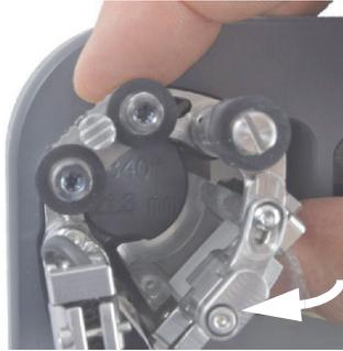
图 2-17 旋转探头架，为外径小于 33.4 毫米的直管定位
