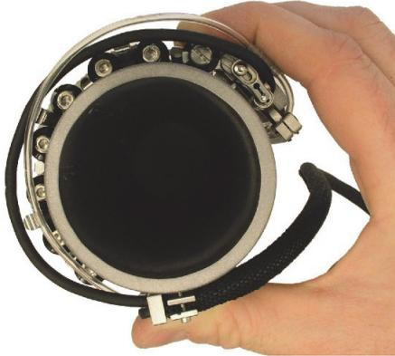
图 2-24 将扫查器绕放在直管上并固定住
