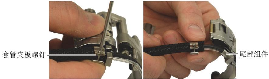
图 2-1 拆下套管夹板
