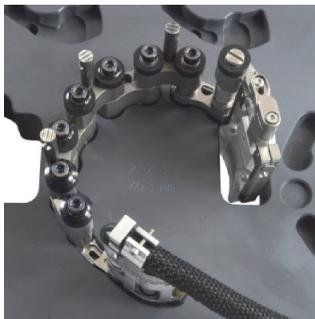
图 2-15 安装母链部件和 / 或中链部件
