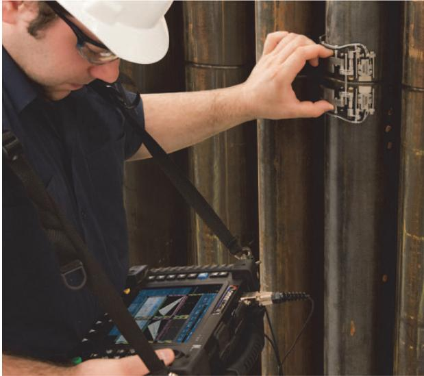
图 i-2 在有限的空间范围内操作 COBRA 扫查器
