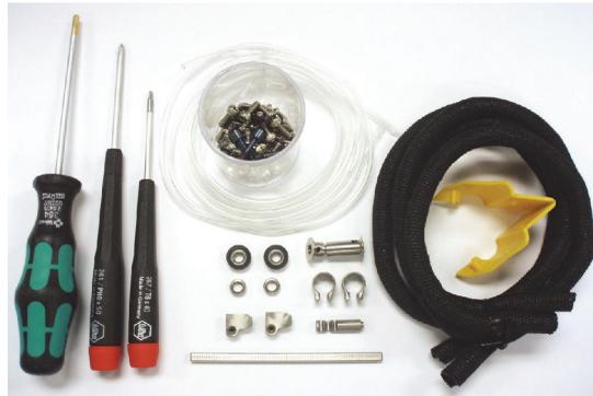
图 4-2 基本备用零件套装中的零件与工具
