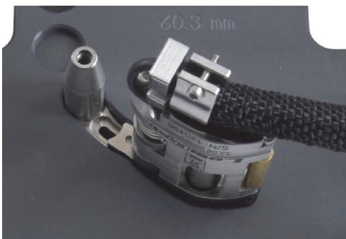
图 2-8 将尾部组件嵌入设置模板的槽中
