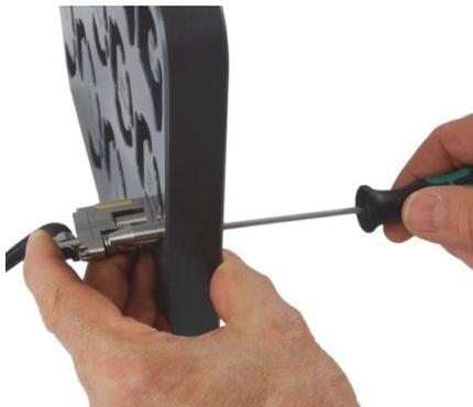
图 2-9 紧固尾部组件的调节螺钉
