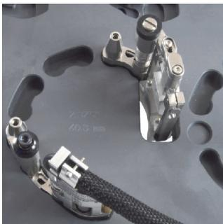
图 2-13 将探头架安装到设置模板中
