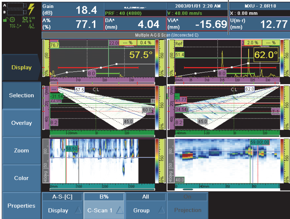
图 7 分析模式下两个组的 A 扫描、S 扫描和 C 扫描
