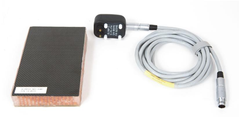
**Abbildung 6-1 Materialien – Ablösung Decklage-Kern (parallel) in Prüfteilen mit flacher oder konstanter Geometrie**
