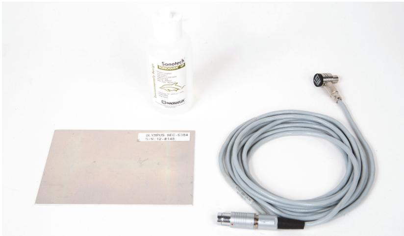
**Abbildung 6-37 Materialien – Ablösung Metall-Metall im Resonanzmodus**
