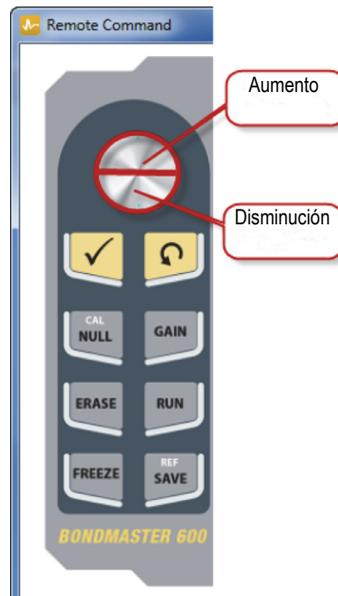
Figura 7-15 Función de grado con la rueda de ajuste
