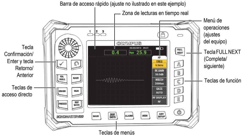
**Figura 3-5 Pantalla de inspección principal y panel frontal del equipo BondMaster 600**
