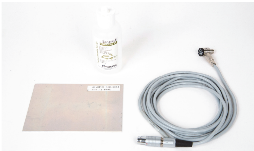
図 6-37 材料 – レゾナンス検査法の使用による金属間の接合検査
