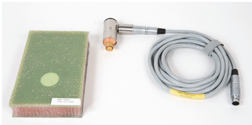
図 6-22 材料 – MIA 検査法を使用した小さな欠陥の検出
