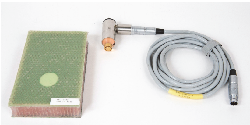
図 6-29 材料 – MIA 検査法による修理済みエリア（ポッティング）の検出
