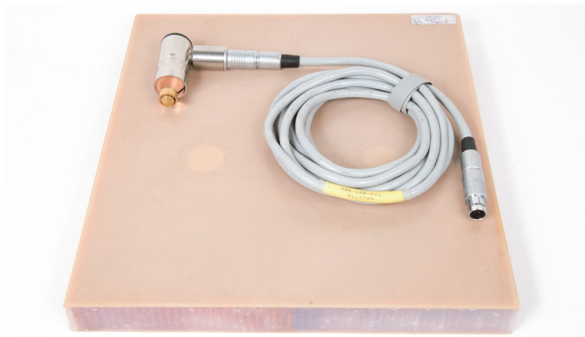
図 6-61 材料 – MIA 検査法を使用した最適な周波数の模索
