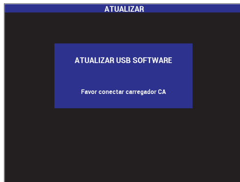
Figura 7-5 Mensagem indicando que o carregador da bateria não está conectado
