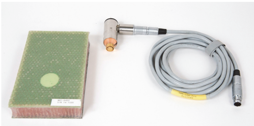
Figura 6-22 Materiais — descolamentos pequenos usando a técnica MIA
