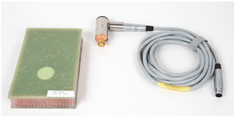
Figura 6-29 Materiais — áreas reparadas (envasamento) utilizando a técnica MIA
