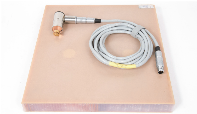
Рис. 6-61 Материалы для определения наилучшей частоты – Режим MIA
