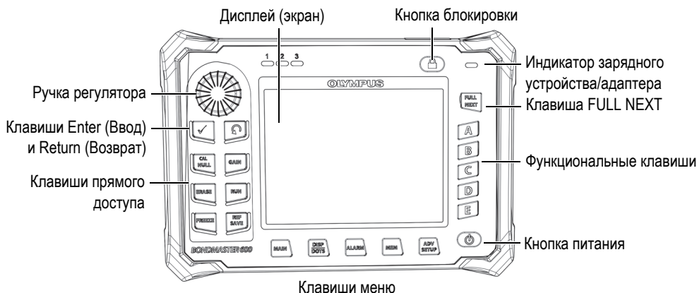
Рис. 2-15 Передняя панель BondMaster 600 — Клавиши и ручка регулятора
