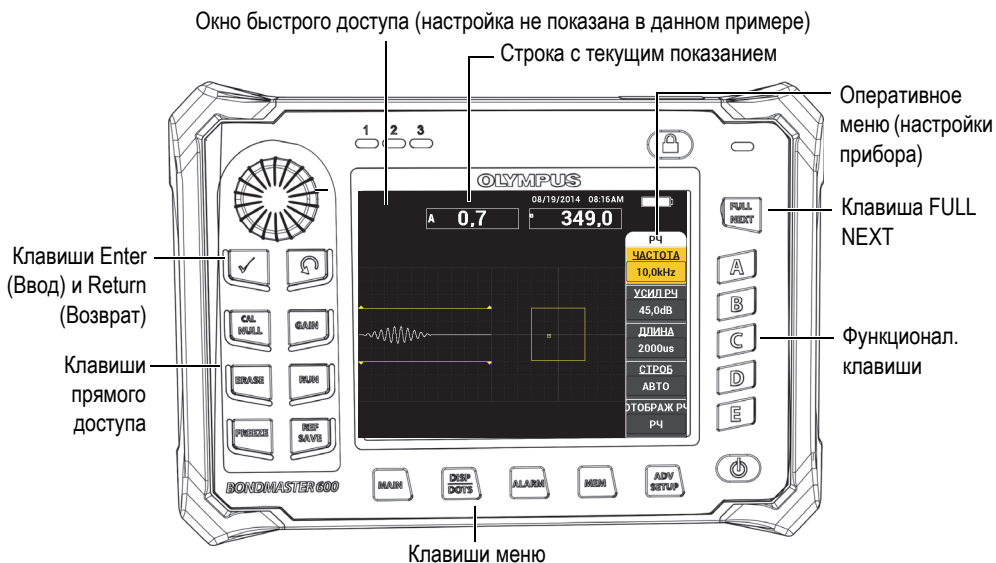
Рис. 3-5 Передняя панель BondMaster 600 и экран измерений
