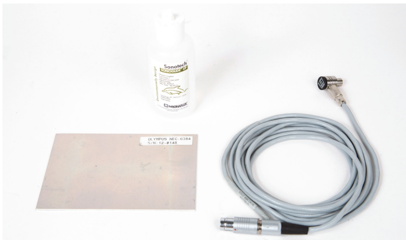
Рис. 6-37 Материалы для выявления отслоений в металлах — Резонансный режим
