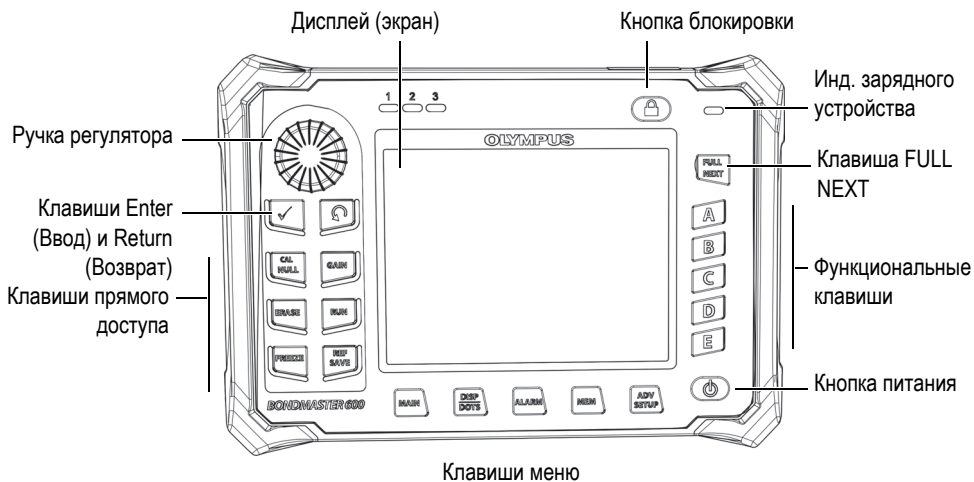
Рис. 5-2 Элементы управления BondMaster 600
