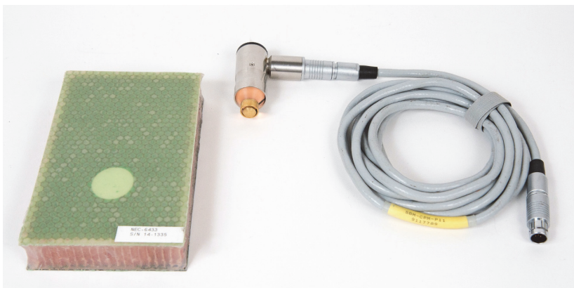
Рис. 6-29 Материалы для выявления отремонтированных участков с использованием режима MIA
