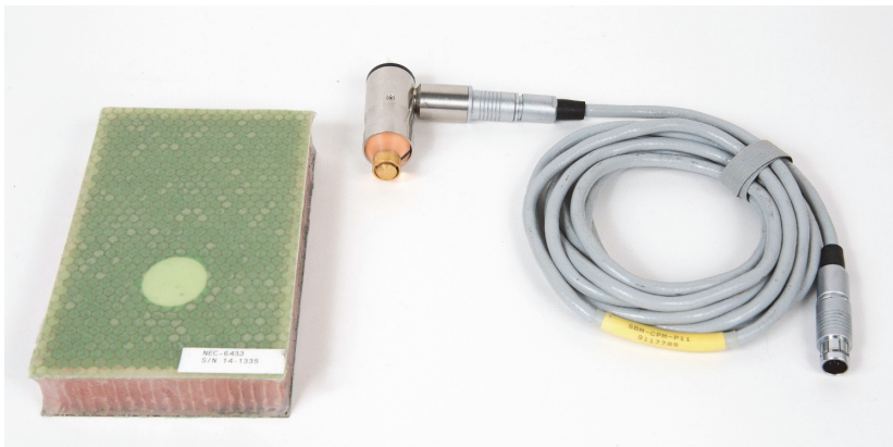
Рис. 6-22 Материалы для выявления мелких отслоений с использованием режима MIA
