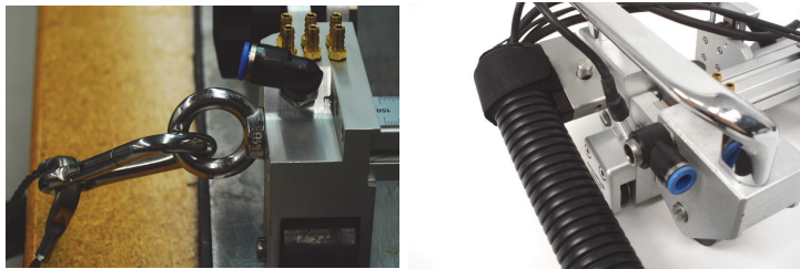
Abbildung 3-1 Befestigen Sie das Verbindungskabel am Befestigungsring
