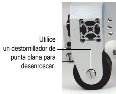
Figura 2-32 Rueda montada en la estructura
