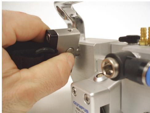
**Figure 2-8 Fixation du câble ombilical**
