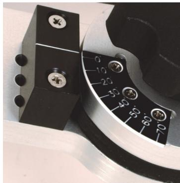
**Figure 2-2 Échelle d'angle**
