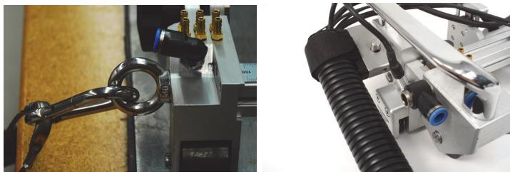
Figure 3-1 Fixation du câble ombilical à l'anneau de fixation
