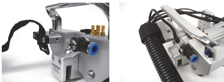
Figure 2-9 Courroie desserrée (à gauche) et courroie resserrée (à droite)
