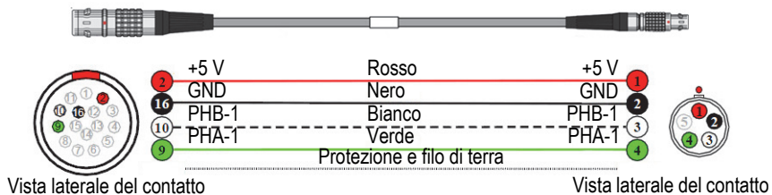
Figura 7-2 Piedinatura dell'encoder
