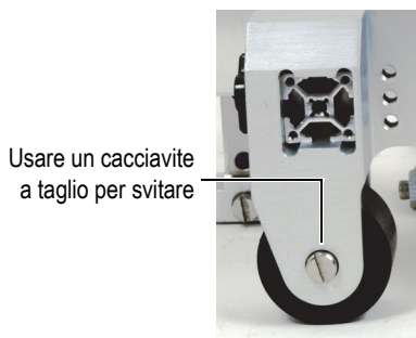
Figura 2-32 Ruotina installata sulla struttura
