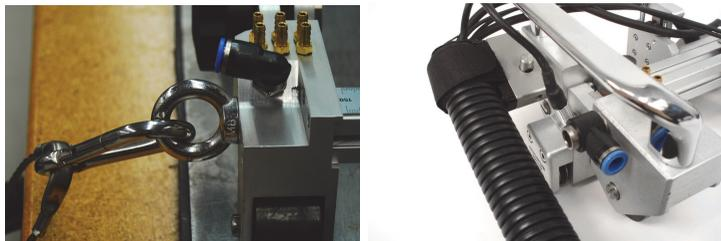
図 3-1 アンビリカルケーブルをアタッチメントリングに取り付ける
