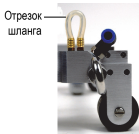
Рис. 3-3 Использование небольшого отрезка шланга для подключения неиспользуемых выходных штуцеров
