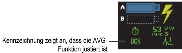
**Abbildung 5-24 Grüne Kennzeichnung AVG für justierte AVG-Funktion**
