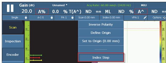
Abbildung 6-18 Die Funktion Indexschritt
