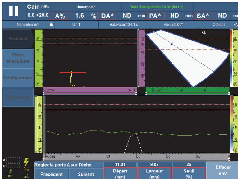
Figure 5-21 Réglage de la porte A sur l'écho d'un groupe PA
