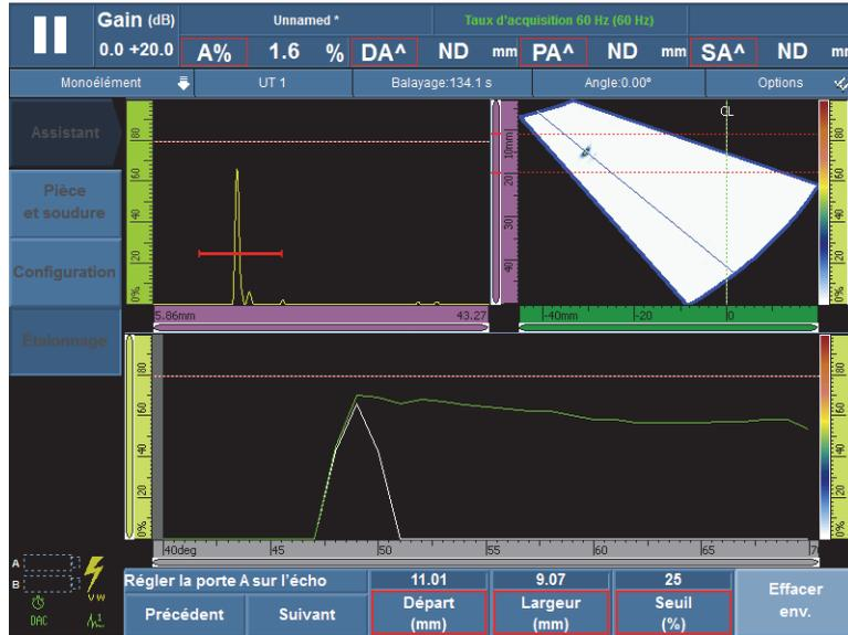
Figure 5-19 Réglage de la porte A sur l'écho d'un groupe PA
