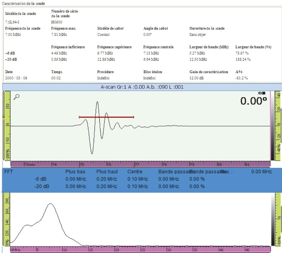
Figure 4-11 Section Caractérisation de la sonde dans un rapport
