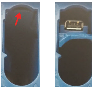
Obrázek 2-3 Zatlačte na kryt ( vlevo ) a vytáhněte skrytý port USB 2.0 ( vpravo )
