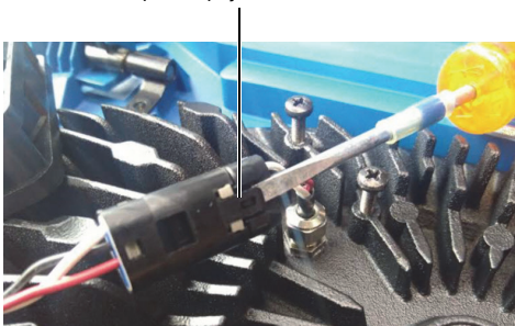
Obrázek 4-3 Odpojení kabelu ventilátoru (vlevo) a konečné umístění (vpravo)
