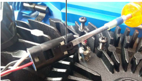
Abbildung 4-3 Trennen des Ventilatorkabels ( links ) und Endmontage ( rechts )
