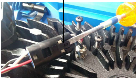
Abbildung 4-3 Trennen des Ventilatorkabels ( links ) und Endmontage ( rechts )
