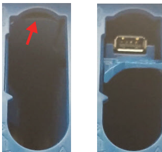
Figura 2-3 Empuje hacia el fondo la tapa ( izquierda ) y aproxime el puerto oculto USB 2.0 hacia fuera ( derecha )
