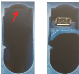
Figure 2-3 Ouverture du petit couvercle (à gauche) et exposition du port USB 2.0 dissimulé (à droite)
