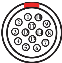
Figura 6-2 Connettore LEMO di allarme e I/O (lato dei contatti)
