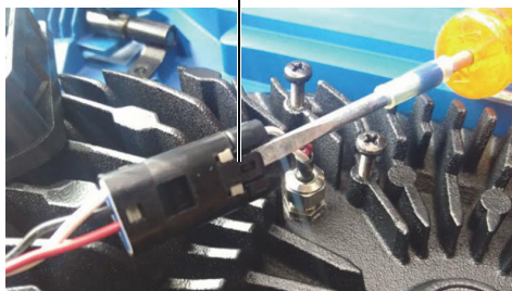
図 4-3 ファンケーブルの取り外し (左) と最終的な位置 (右)
