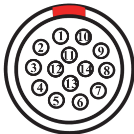
Figura 6-2 Alarme e conector LEMO I/O (visualização de contato)
