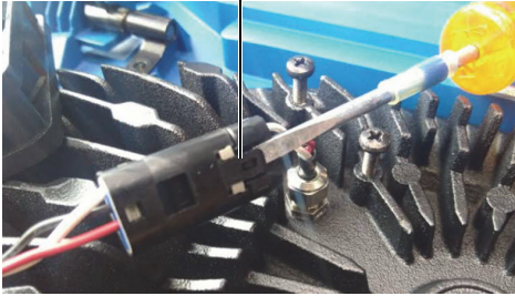
Figura 4-3 Desconexão do cabo da ventoinha ( esquerda ) e a localização final ( direita )
