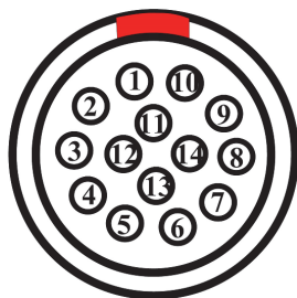
图 6-2 报警和I/O的LEMO接口（接触面视图）
