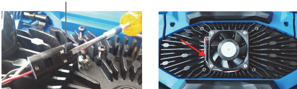
图 4-3 断开风扇的电缆（左图）和最终装好电缆（右图）
