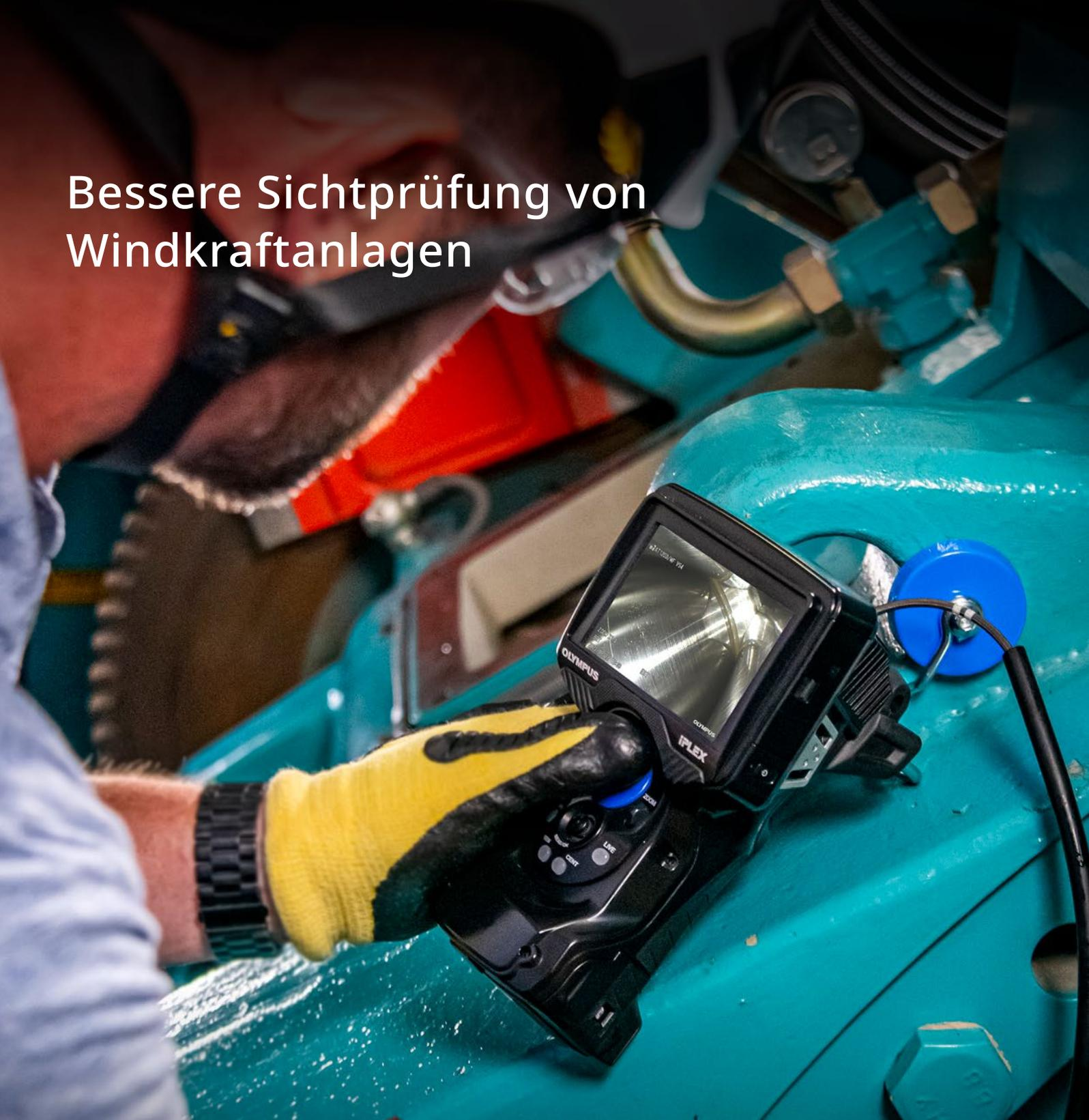
Das portable IPLEX G Lite Videoskopmodell für Windkraftanlagen eignet sich mit seinen leistungsstarken Bildgebungsfunktionen in einem kleinen Gehäuse für die Prüfung in Gondeln von Windkraftanlagen bei beengtem Platz und kann die Arbeit erleichtern. Diese IPLEX G Lite Videoskopmodell verfügt über Funktionen, die speziell für die Sichtprüfung von Windkraftanlagen entwickelt wurden, z. B.:
