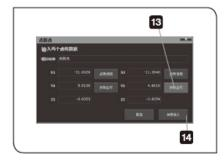
13 在[点到点的距离]窗口中,单击[X2/Y2/Z2]的[获取坐标] 按钮。
