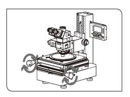
2 移动显微镜的载物台,使实时窗口的十字线中心与输入 点相重合。
