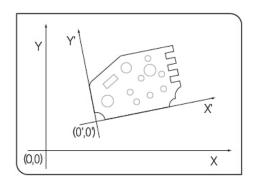
自定义坐标是通过软件,设置一个独立于参考坐标系统 (计数器坐标XY)的新原点(0',0')和坐标系(自定义 坐标X'Y')的功能。
