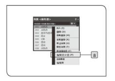
◎ 在[列表]窗口中右键单击测量项,并在显示的菜单中选择[编辑设计值] a 时,可以编辑这些测量项的设计值或公差值。有关详情,请参阅"设置测量项的设计值和 Excel®转换数据"(第 99 页)。
