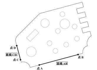
使用点到点的测量创建了直线 AB。 通过复制直线 AB 中使用的点到点的测量创 建直线 CD。
