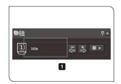
确认[物镜]窗口中的物镜倍率与要使用的物镜倍率相同。
