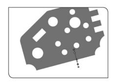
基于单击的点,创建一条直线,然后检测一个边缘。 12 如果十字线位置与实时图像的边缘不相匹配,请移动● 标记或■标记调节十字线位置。
