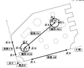
通过指定直线 AB 和直线 CD,可以测量点到点的距离、坐标差 X 和坐标差 Y。
