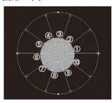
输入点位置从 3 点钟方向起逆时针旋转,遵循输入点 1-输入点 2-输入点 3 等的顺序。
