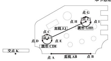
通过指定直线 AB,可以测量点到点的距离、 坐标差 X 和坐标差 Y。
