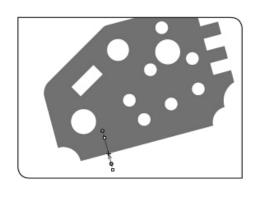
基于单击的点, 创建一条直线, 然后检测一个边缘。 检测到的边缘以浅蓝色十字线显示。
