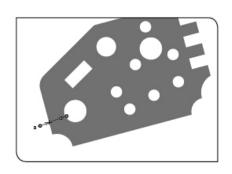
基于单击的点,创建一条直线,然后检测一个边缘。 如果十字线位置与实时图像的边缘不相匹配,请移动● 标记或■标记调节十字线位置。
