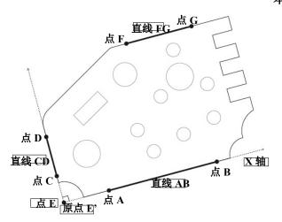
通过指定直线 AB 和直线 CD,可以测量点到点距离、坐标差 X 和坐标差 Y。
