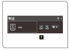
1 请确认[物镜]窗口中物镜的倍率与要使用的物镜的倍率 相同。
