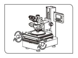
5 移动显微镜的载物台,采集直接测量中其它圆形圆周上的3个点。
