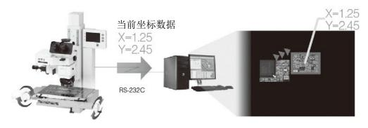
2.单击采集按钮时,当前视场被拼接到大范围图像。 因为是根据坐标值拼接图像,所以可以精确地拼接图像。
