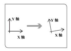
◎ 实时图像上的 X 轴和 Y 轴与自定义坐标系的 X 轴一起倾斜。
