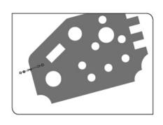
基于单击的点,创建一条直线,然后检测一个边缘。 如果十字线位置与实时图像的边缘不相匹配,请移动● 标记或■标记调节十字线位置。
