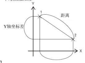
两个点的距离 两个点之间的X坐标差 两个点之间的Y坐标差
