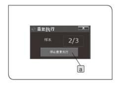
◎ 重复执行测量时,出现[重复执行]窗口。单击[停止重复 执行]按钮,停止重复执行测量。
