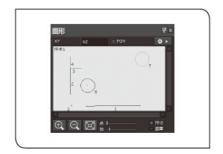
14 采集点 J、点 K 和点 L 的坐标数据。 创建了一个通过点 J、点 K 和点 L 的圆形 JKL。
