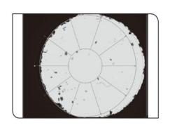
7 拖曳显示的圆形工具的中心,确定测量点。
